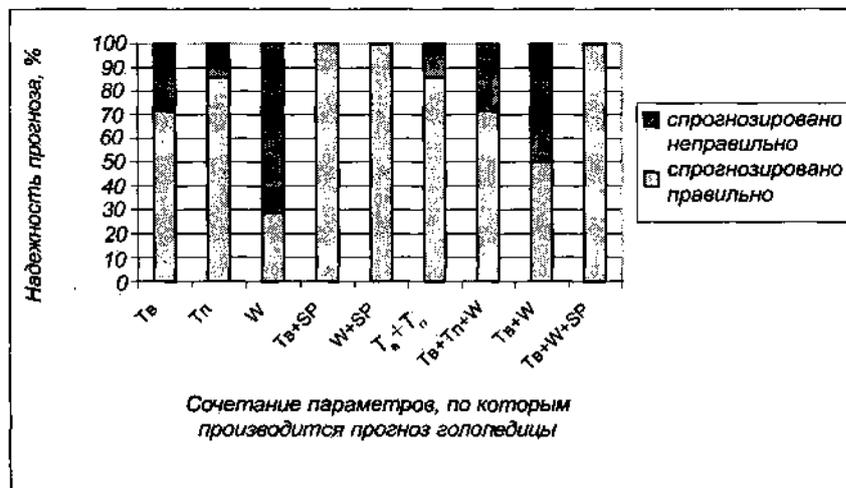
**Рис. П.1. Результаты проверки надежности прогноза гололедицы с использованием различных физико-статистических моделей**
