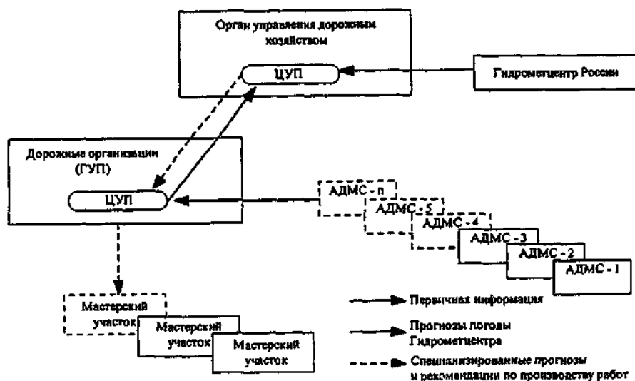
Рис. 3.1. Примерная схема получения и передачи информации о погодных условиях на автодороге
