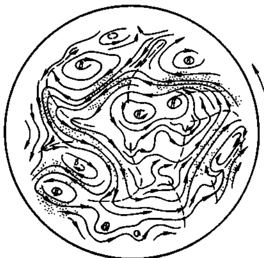
Рис. 43. Линии тока поверхностных течений воды во вращающемся цилиндрическом сосуде с нагревом по краям (по Фульду с соавторами [310]). Внешний радиус L = 15,7 см; глубина слоя воды H = 6 см; скорость вращения \omega = 0,75 сек -1 против часовой стрелки; нагрев начал за 3,5 мин до измерения; температура воды 33° С; в струях K_{i,r} = 0,15 , в целом K_{i,r} = 0,02 ; Ri \sim 50 ; Re \sim 1400 ; заштрихованы области наиболее быстрых струйных течений.
