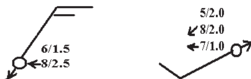
Рис. 4.6. Наноска параметров волнения на картах анализа волны
