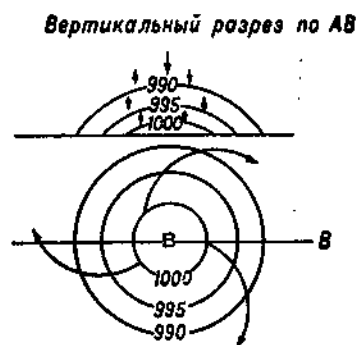
Рис. 21.7. Схема воздушных течений в антициклоне.
