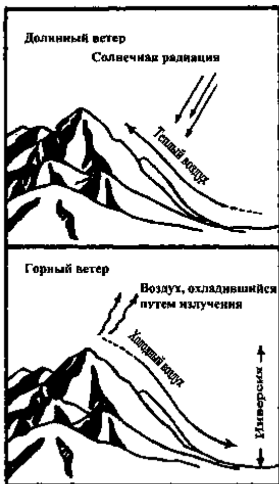
Рис.17 Движение воздуха при горном и долинном ветре
