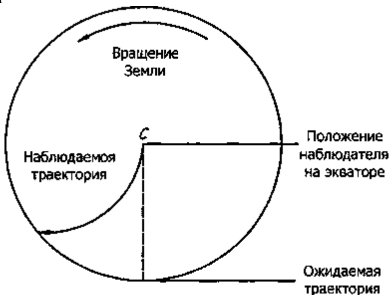
Рис.1 Результат действия силы Кориолиса на предмет, движущийся с севера на юг
