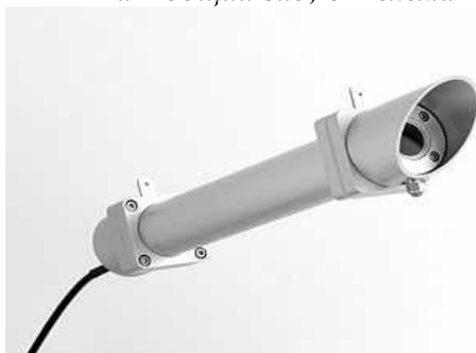
Рис. 6. Современный пиргелиометр DR01 фирмы Hukseflux
