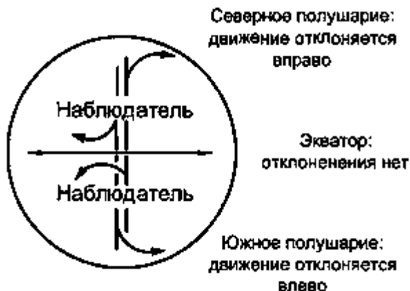
Рис.2 Действие сил Кориолиса на различных широтах
