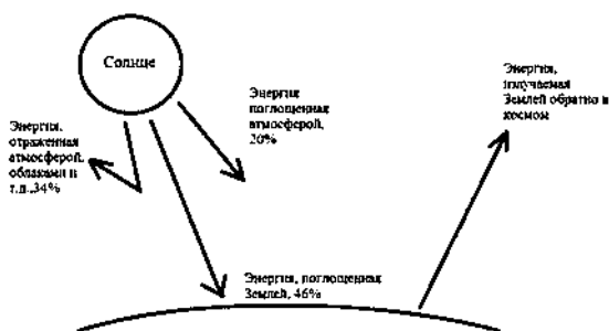
Рис.1.1.Схема отражения, поглощения и собственного излучения энергии на Земле
