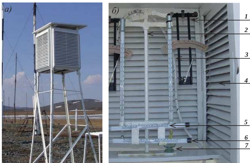
Рис. 5. Метеорологическая будка (а) и размещенные в ней приборы (б).
