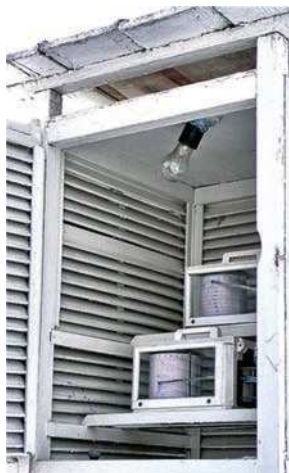
Рис. 16. Приборы-самописцы в метеорологической будке.
