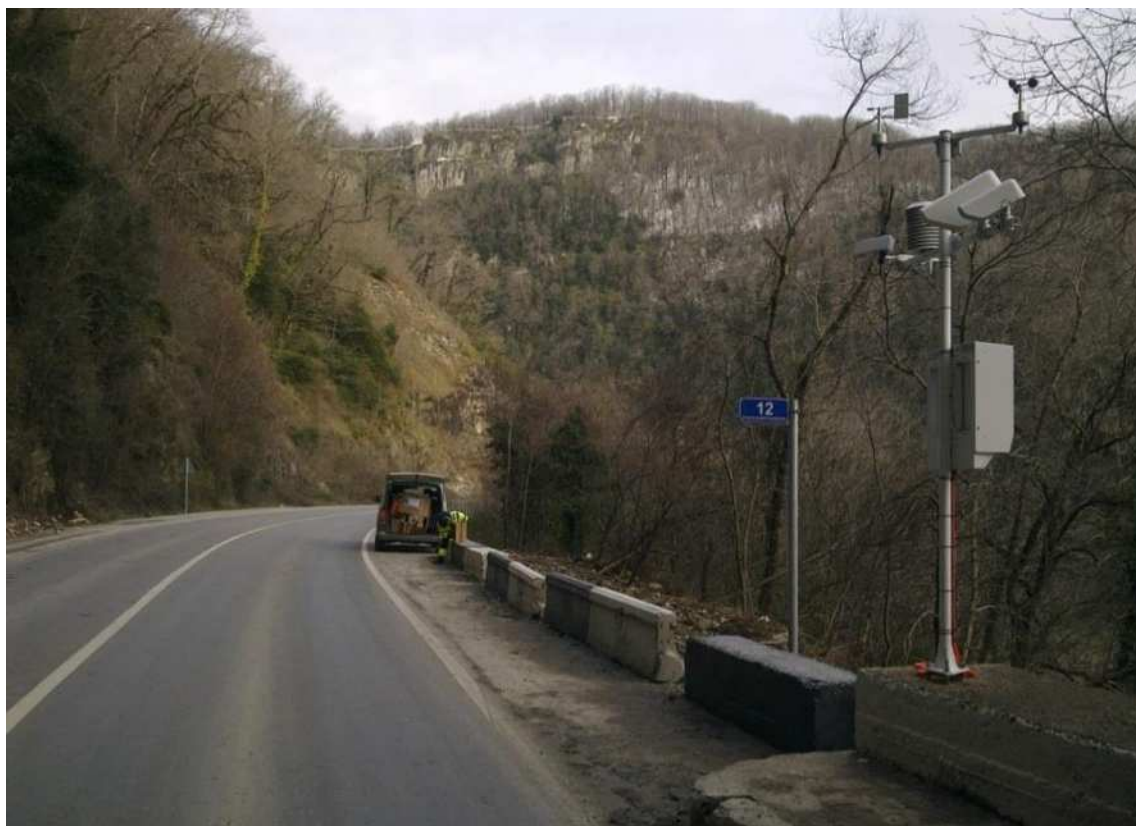
Рисунок 90 – Пример установки АДМС «Вуокса» (производство ЗАО «Институт Радарной Метеорологии»)
