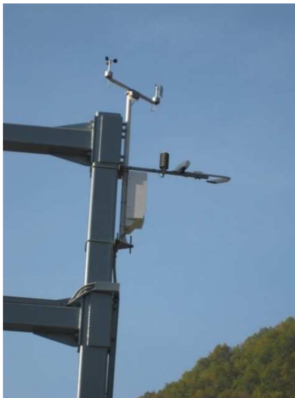
Рисунок 84 – Внешний вид АДМС ROSA, установленной на П-образной опоре
