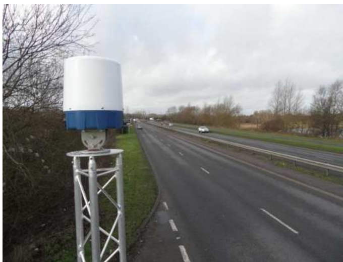
Рисунок 75 – Внешний вид радара ClearWay CTS350-X
