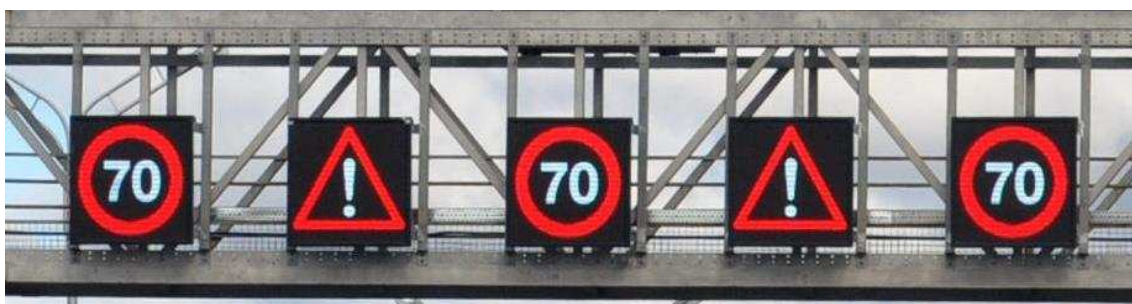
Рисунок 43 – Пример светотехнических дорожных знаков переменной информации
