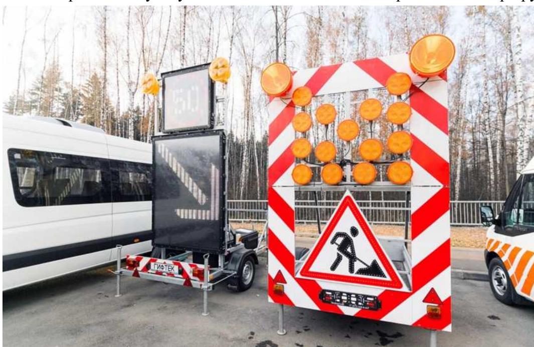
Рисунок 50 – Внешний вид мобильных комплексов, применяемых для информирования участников дорожного движения на федеральной автомобильной дороге М-1 «Беларусь» (обход г. Одинцово)
