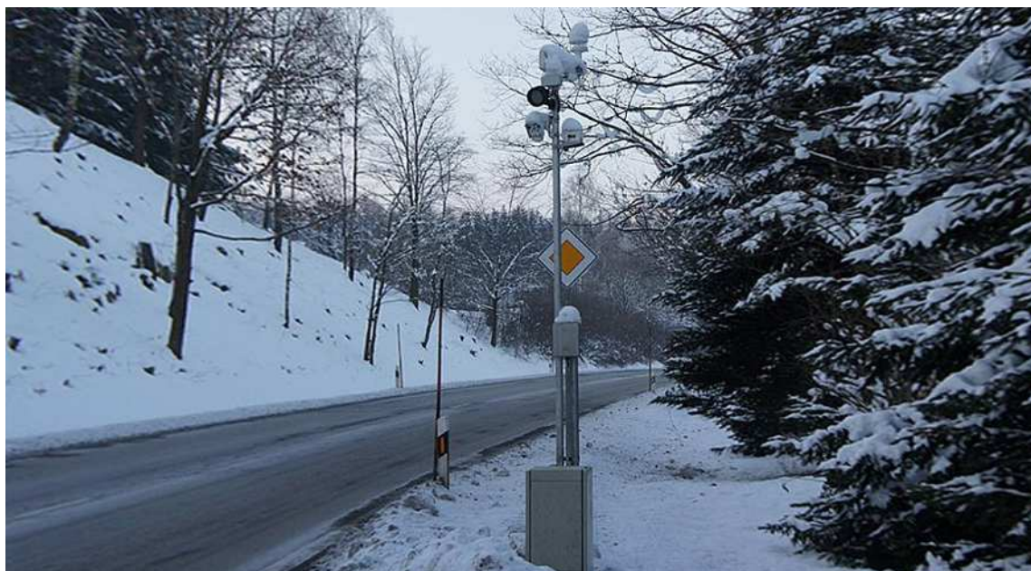
Рисунок 87 – Пример установки АДМС RCM 500NT (производство Boschung Mecatronic)
