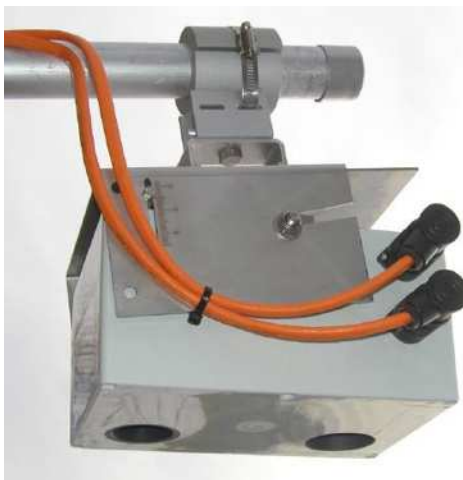
Рисунок 10 – Внешний вид датчика производства тройной технологии (производство ASIM)
