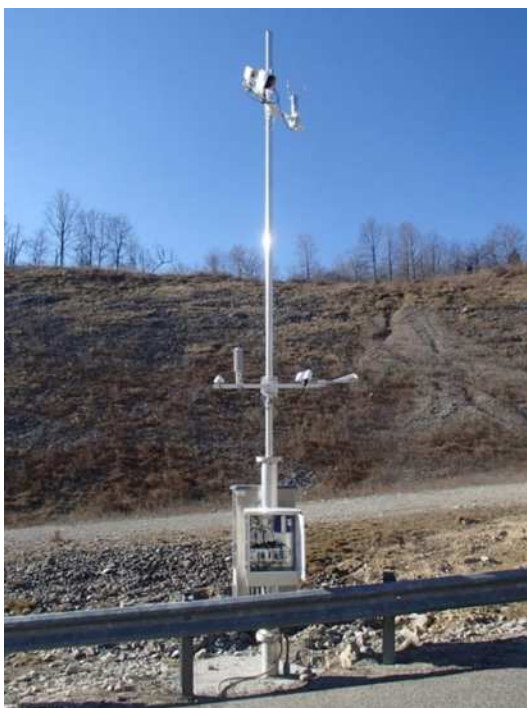
Рисунок 88 – Пример установки АДМС RWS 200 (производство Vaisala)
