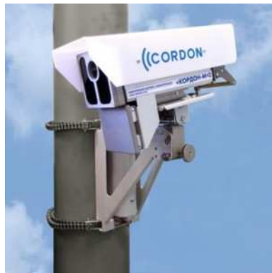
Рисунок 21 – Внешний вид фото-радарного блока «Кордон-М» 2
