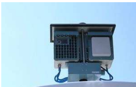
Рисунок 24 – Стационарный комплекс автоматической фиксации нарушений ПДД «КРЕЧЕТ-С»
