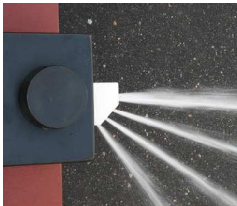
Рисунок 60 – Пример распределения реагента по поверхности дороги
