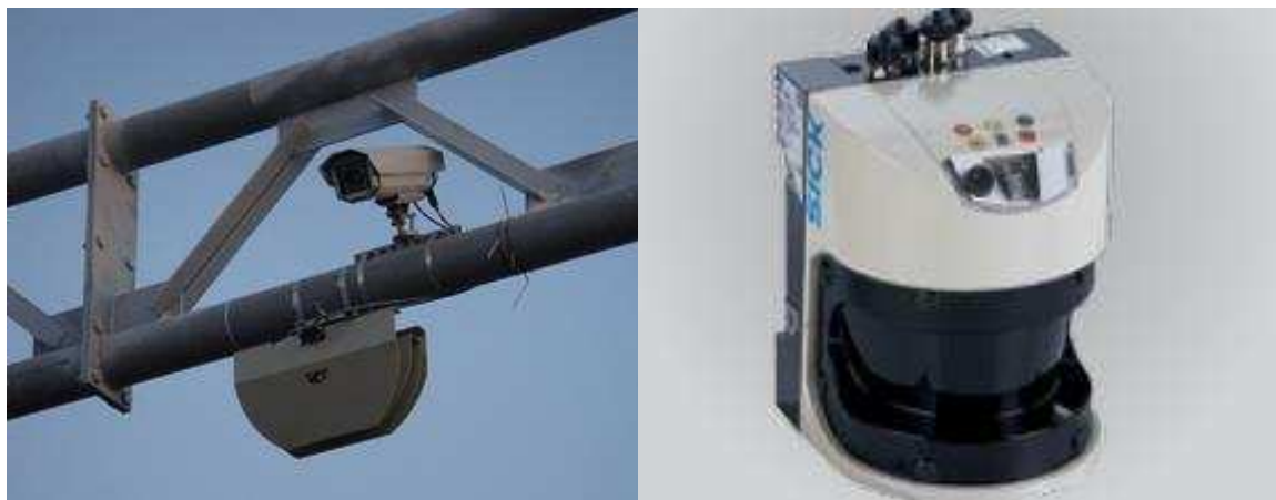
Рисунок 66 – Примеры внешнего вида датчиков по измерению габаритов ТС
