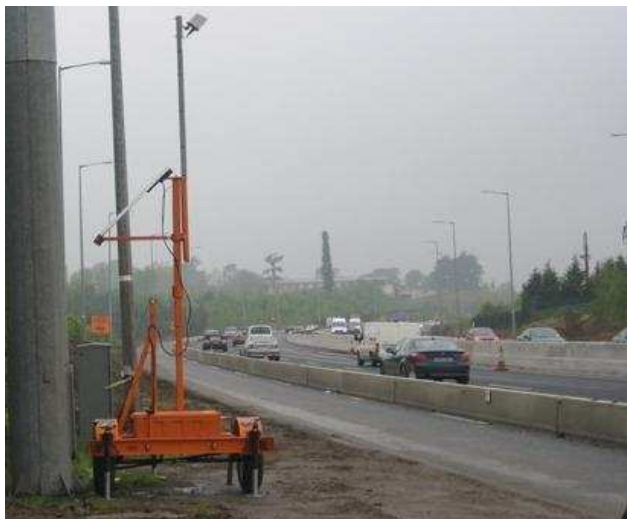
Рисунок 18 – Пример применения мобильного комплекса детектирования параметров транспортных потоков
