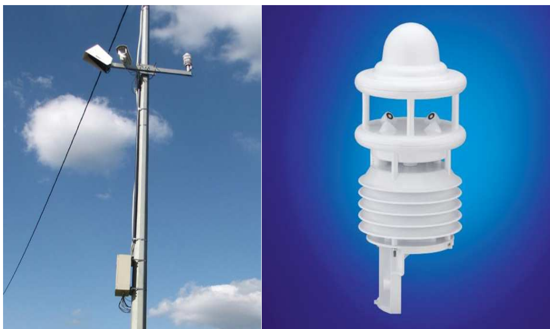
Рисунок 86 – Внешний вид компактного метеофункционала WS600 –UMB (производство Lufft)
