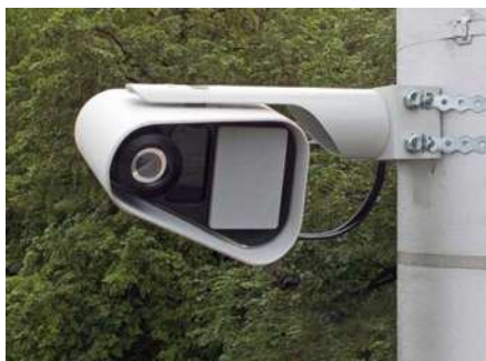
Рисунок 24 – Стационарный комплекс автоматической фиксации нарушений ПДД «КРЕЧЕТ-С»
