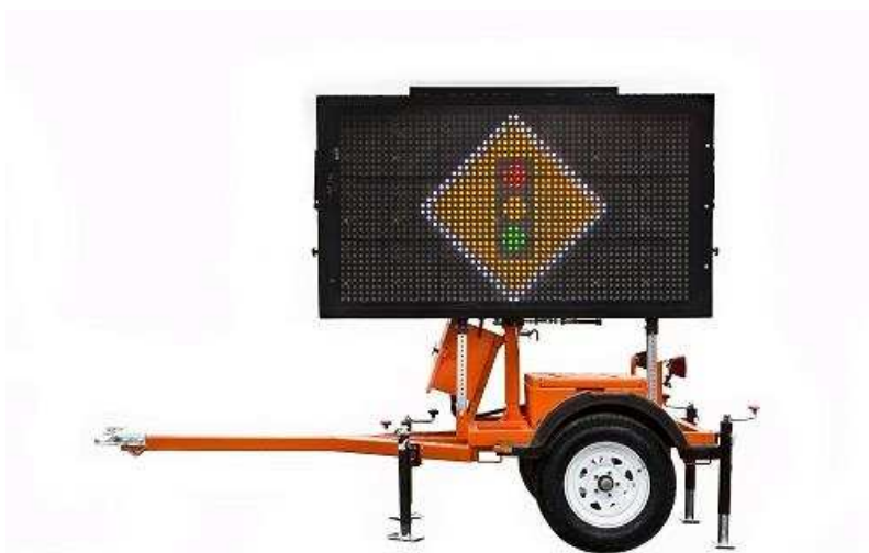
Рисунок 52 – Пример внешнего вида мобильных ДИТ
