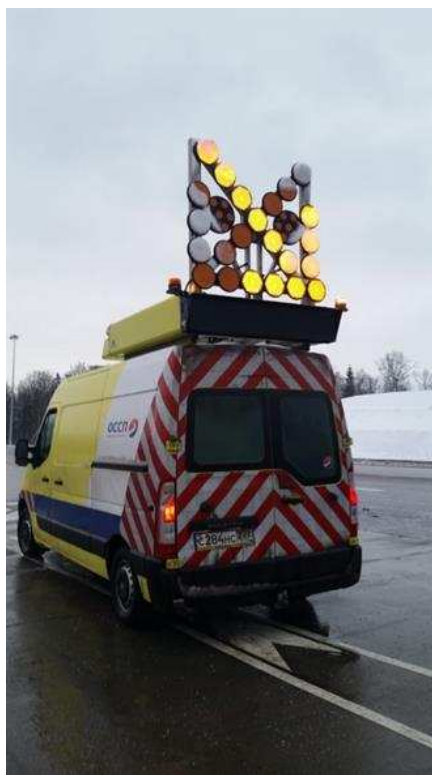
Рисунок 51 – Внешний вид мобильного ЗПИ, установленного на транспортном средстве и применяемого для информирования участников дорожного движения на федеральной автомобильной дороге М-11
