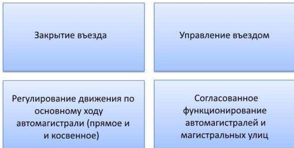
Рисунок 3 – Основные формы управления движением на автомагистралях
