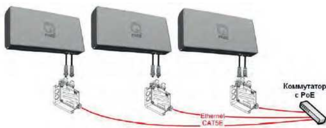
Рис. 75. Подключение приемопередатчиков DSRC
