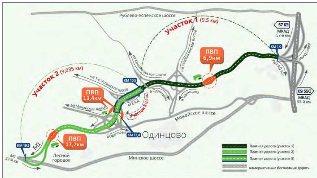
Рис. 25. Схема прохождения автомобильной дороги «Новый выход на МКАД с федеральной автомобильной дороги М-1 “Беларусь”»
