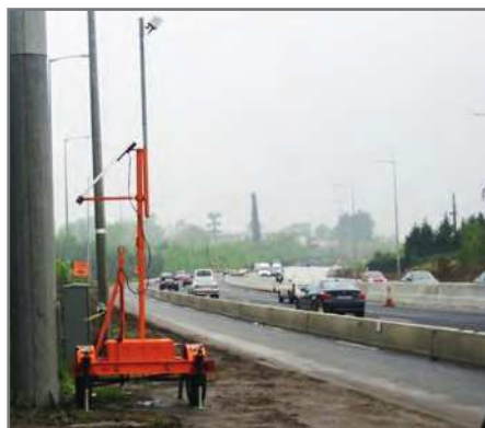
Рис. 36. Пример применения мобильного комплекса детектирования параметров транспортных потоков
