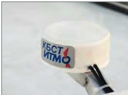
Рис. 68. Пример установки мобильного антенного модуля на автобусе
