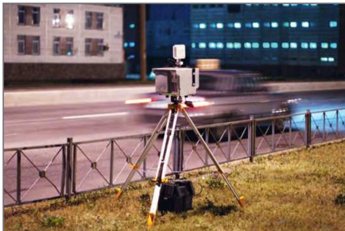
Рис. 45. Пример установки мобильного фоторадарного комплекса
