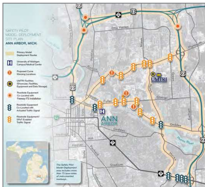
Рис. 59. Схема развертывания пилотной зоны кооперативной ИТС в Анн-Арборе, Мичиган
