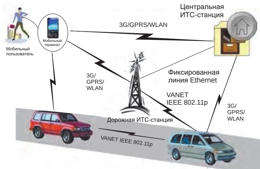
Рис. 78. Кооперация мобильной и наземной связи в кооперативных ИТС
