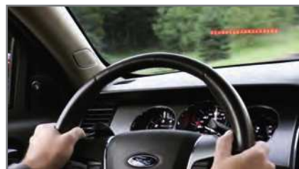
Рис. 50. Пример информирования водителя об опасности (резко остановившееся впереди транспортное средство) путем отображения сигнала на лобовом стекле — яркой красной мигающей полосы
