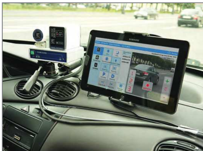
Рис. 46. Пример работы комплекса фиксации нарушений ПДД в патрульном автомобиле
