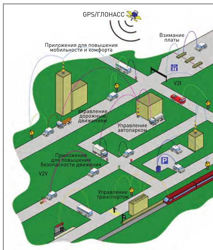
Рис. 82. Общая схема функциональных связей кооперативных ИТС
