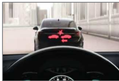
Рис. 51. Пример информирования водителя об опасности (резко остановившееся впереди транспортное средство) путем отображения сигнала на лобовом стекле — яркого изображения силуэтов автомобилей
