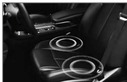
Рис. 53. Пример информирования водителя об опасности путем срабатывания вибродатчиков, встроенных в водительское сиденье
