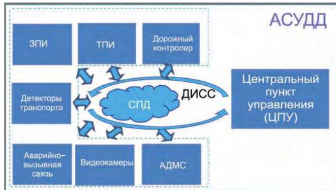
Рис. 19. Структурная схема АСУДД Дублера Курортного проспекта
