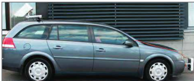
Рис. 41. Пример типовой установки мобильной метеорологической станции
