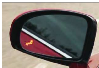
Рис. 52. Пример информирования водителя об опасности перестроения на боковом зеркале автомобиля
