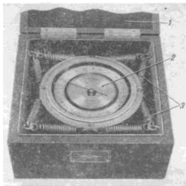
Рис. 5.20. Барометр-анероид М-67: 1 — крышка футляра; 2 — анероид; 3 — амортизаторы
