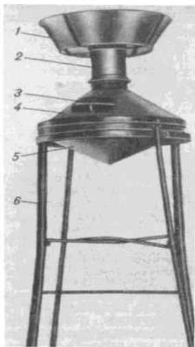
Рис. 4.11. Осадкомер суммарный: 1 — ветровая защита; 2 — труба; 3 — окно с задвижкой; 4 и 5 — верхняя и нижняя части водосборного сосуда; 6 — подставка
