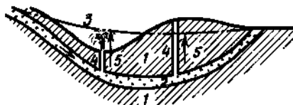
Рис. 5.3. Схема размещения артезианских вод: 1 — водоупорный пласт, 2 — артезианский водоносный горизонт, 3 — линия напора (пьезометрическая линия), 4 — скважины, 5 — высота подъема артезианских вод через скважины
