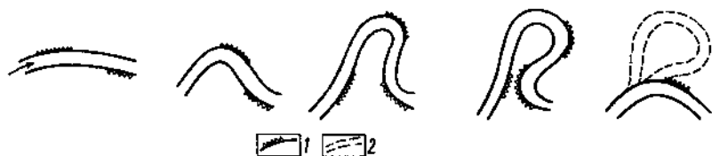
Рис. 6.22. Схема смещения и изменения формы излучины: 1 — участок размыва берега, 2 — старца
