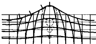
Рис. 10.9. Вертикальное строение волны зыби. Поплавки на волне, пунктиром показаны орбиты частиц
