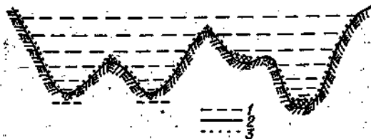
Рис. 2.11. Определение профиля водного сечения аэрофотосъемками последовательных затоплений.
