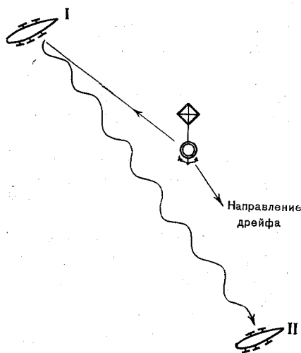
Рис. 17.1. Определение течений по радиолокационным измерениям места судна относительно неподвижной вежи.
