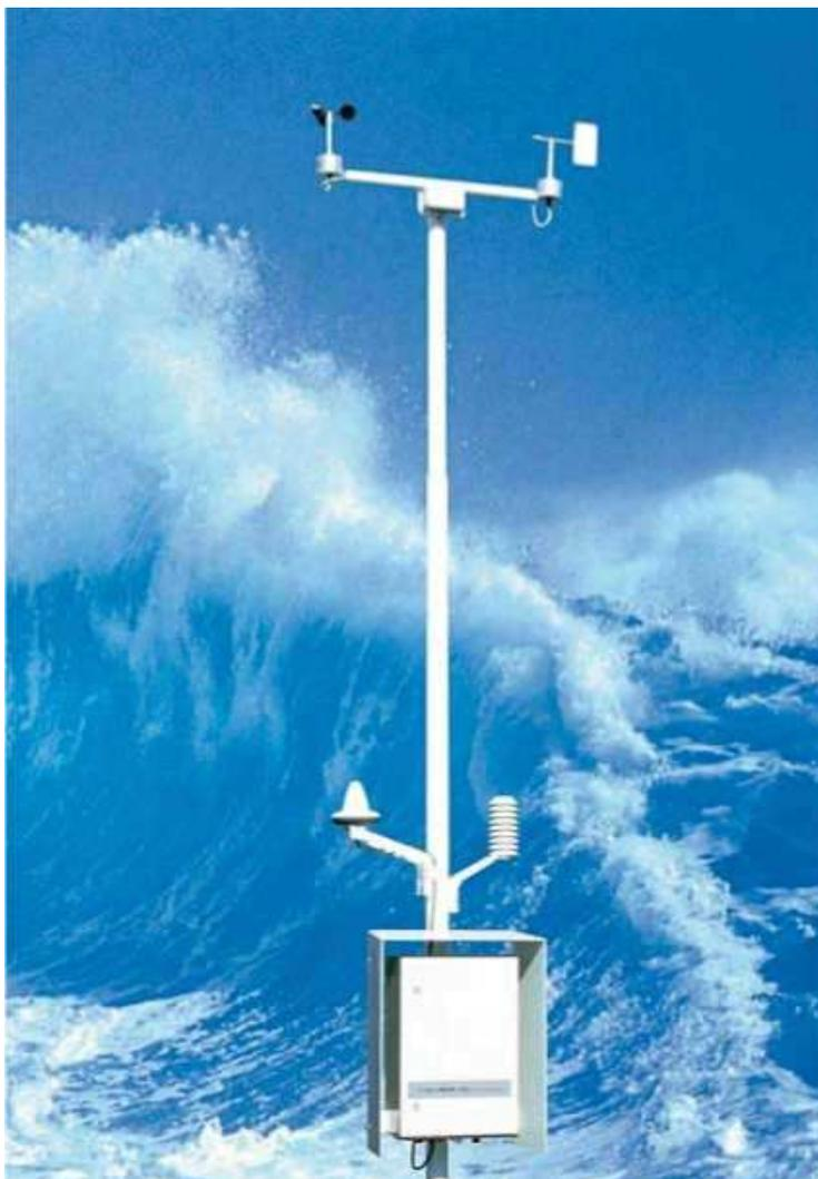
**Рис.15.1** Судовая автоматическая метеостанция AWS (фирма Vaisala, Финляндия)
