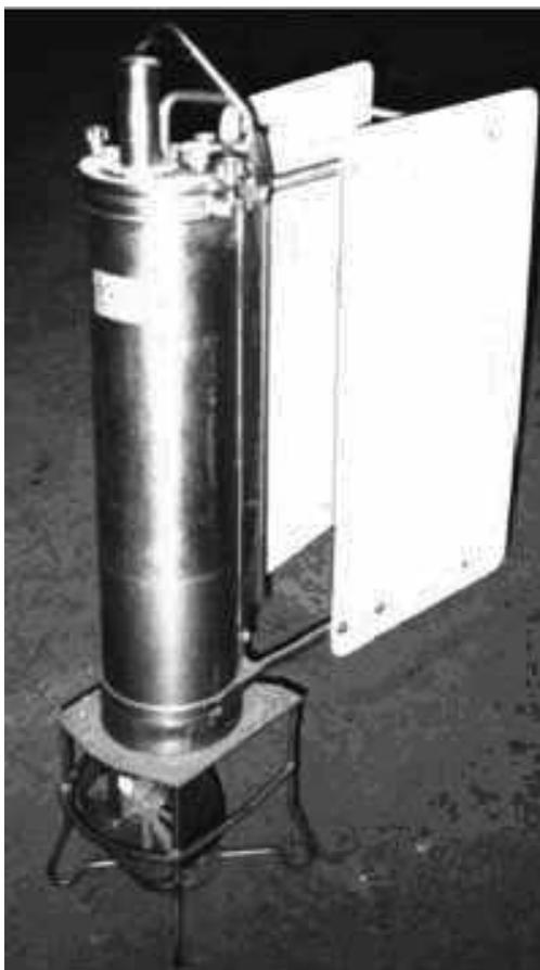
**Рис. 12.7** Базовая модель измерителя течений и температуры «Поток-3».
