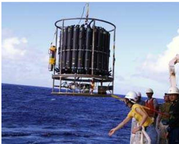
Рис. 16.9 Судовой кассетный пробоотборник воды («розетка»)
