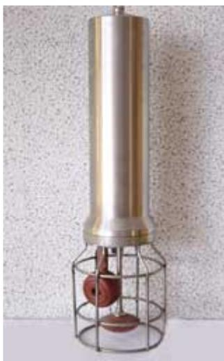
Измерение скорости и направления течения, температуры, удельной электрической проводимости воды и гидростатического давления (глубины погружения модуля) в режиме реального времени и при автономной постановке.
