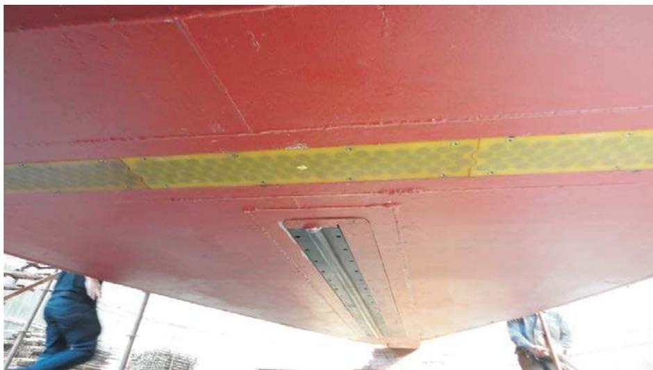
**Рис.6.18** Пример врезки МЛЭ ATLAS в днище судна
