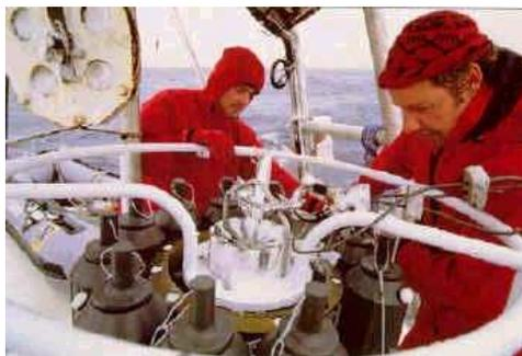
Рис. 7.2 Развертывание батометрической секции SBE 32.
