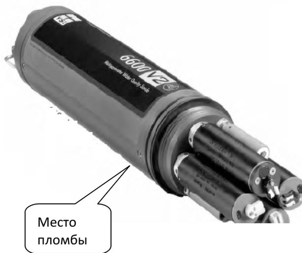
Рис.9.2 Внешний вид зонда гидрологического YSI 6600
