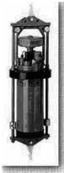
Рис.12.10 Измеритель течений RCM-9
