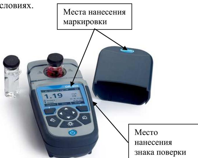
**Рис. 16.22** Общий вид спектрофотометра DR 900 с обозначением мест нанесения маркировки и знака поверки
