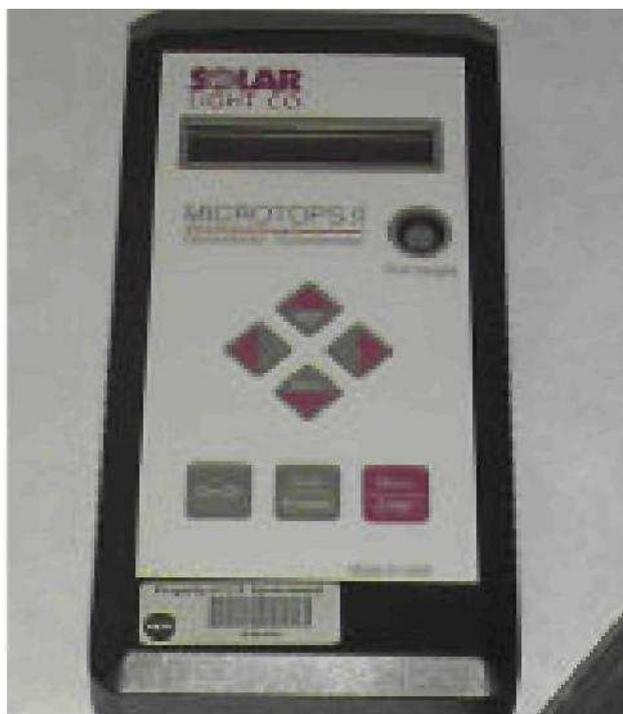
Рис.15.3 б) Портативный солнечный фотометр Microtops
