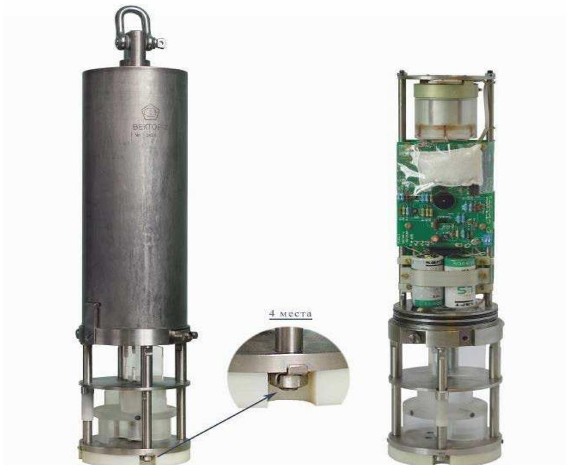
**Рис.12.6** Общий вид измерителя скорости и направления течений «Вектор-2» (в корпусе и без корпуса) и места пломбирования
