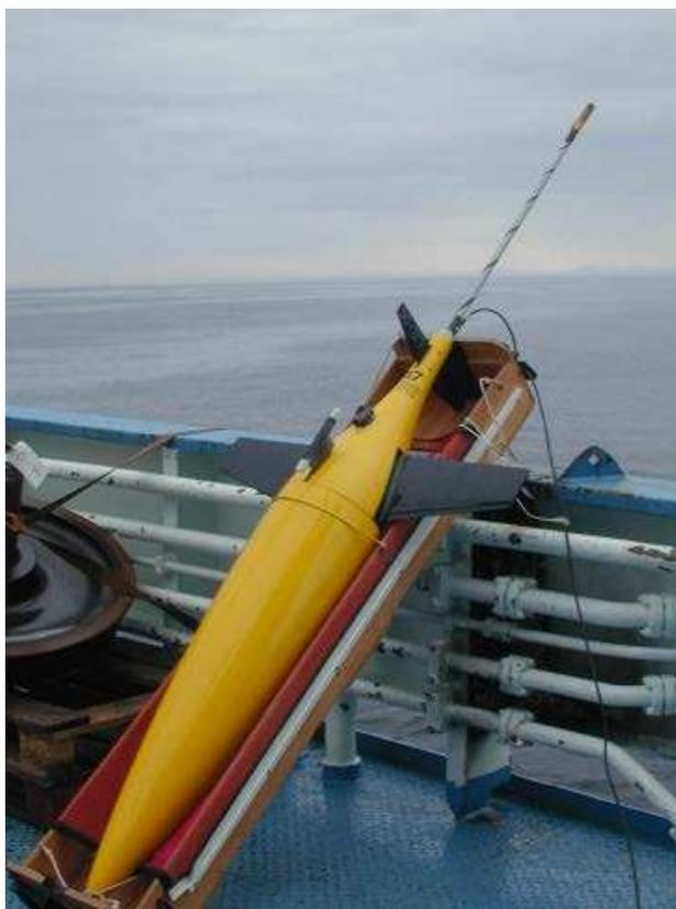
**Рис. 17.17** Внешний вид автономного глайдера, готового к запуску
