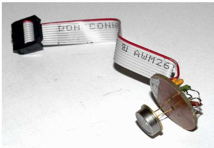
**Рис.14.11** Фотодиод с прецизионным усилителем
