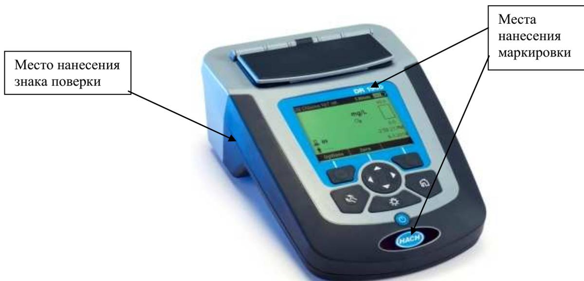
**Рис.16.21** Общий вид спектрофотометра DR 1900 с обозначением мест нанесения маркировки и знака поверки
