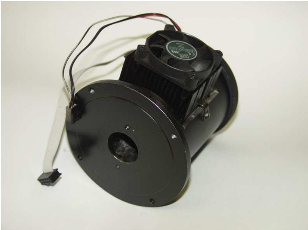
**Рис.14.7** ФПУ в сборе с радиатором и вентилятором
