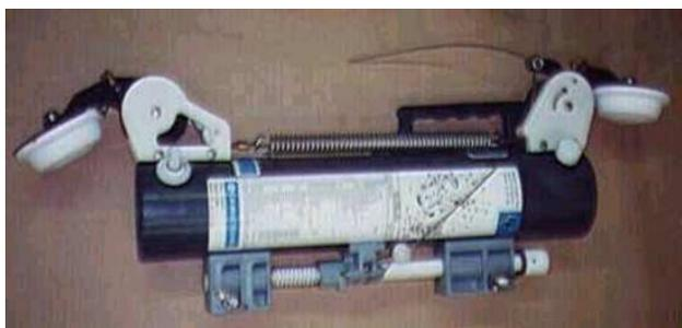
Рис.7.7. Модель *1011 Lever Action Niskin*.
