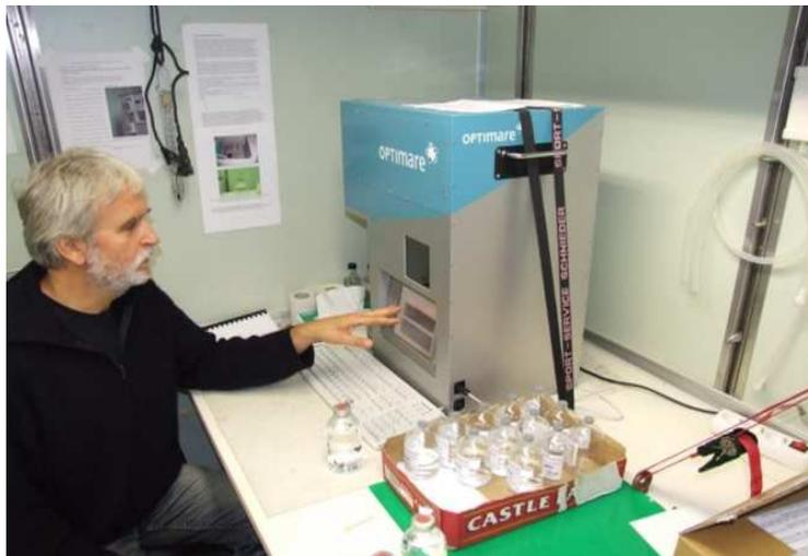
**Рис.6.4** Пример интерьера термостабилизированной лаборатории на немецком RV Polarstern. Показан высокоточный калибровочный солемер и работающий с ним оператор. На стенах видны полозья для закрепления коушей на любой высоте. За эти коуши можно закреплять широкий спектр измерительных лабораторных устройств, нуждающихся в стабильной температуре. Площадь лаборатории на фотографии 10 м<sup>2</sup>.
