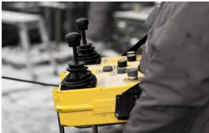
**Рис. 6.16** Внешний вид ручного, переносного, дистанционного (подключается через кабель) пульта управления лебедкой или краном
