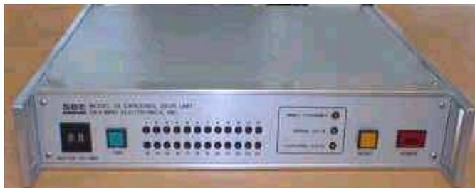
**Рис. 7.3** Терминал для управления батометрической секцией *SBE 33*
