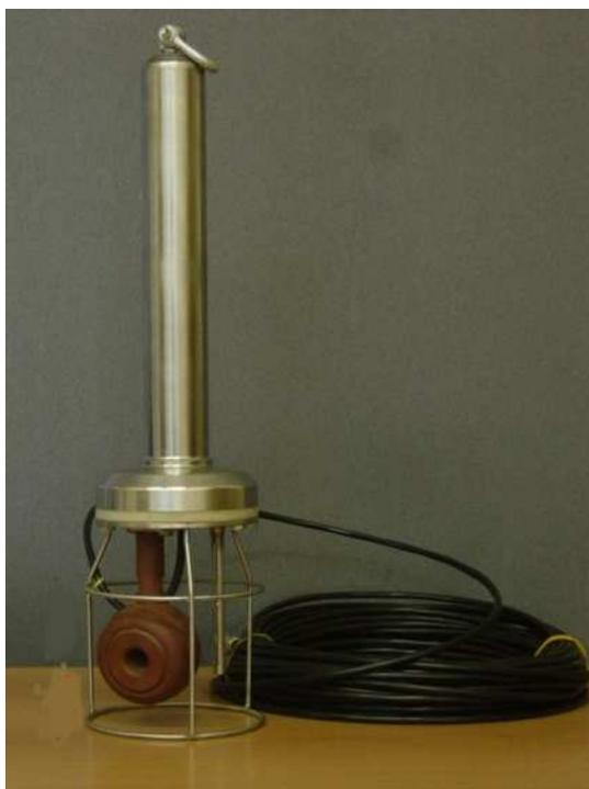
**Назначение и область применения:** измерение температуры, удельной электрической проводимости (солености) морской и распресненной воды на глубинах до 25 м.
