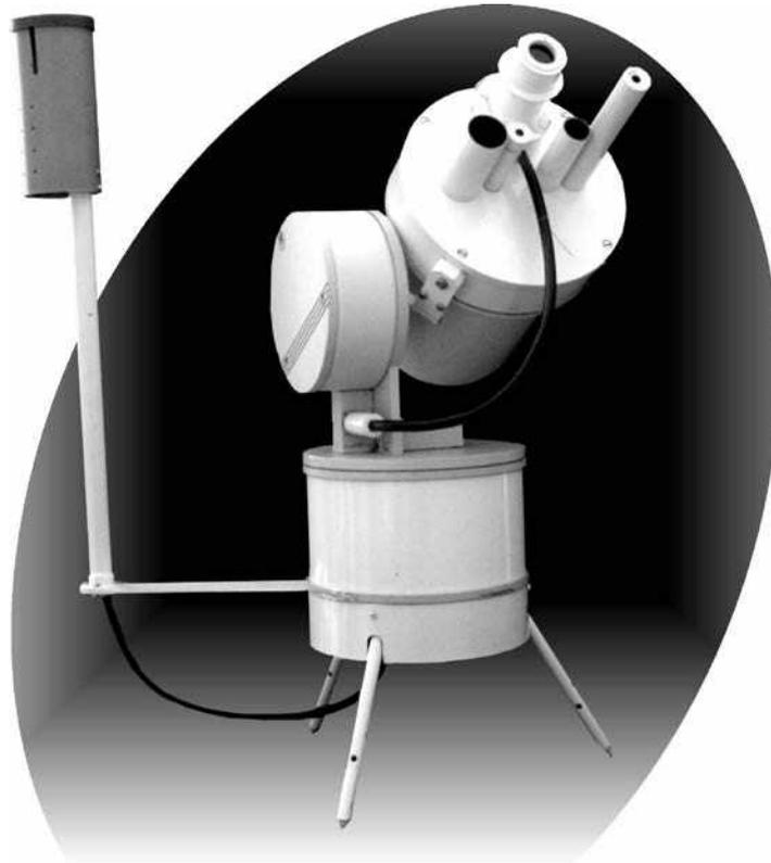
**Рис.15.8** Внешний вид солнечного фотометра SP-6
