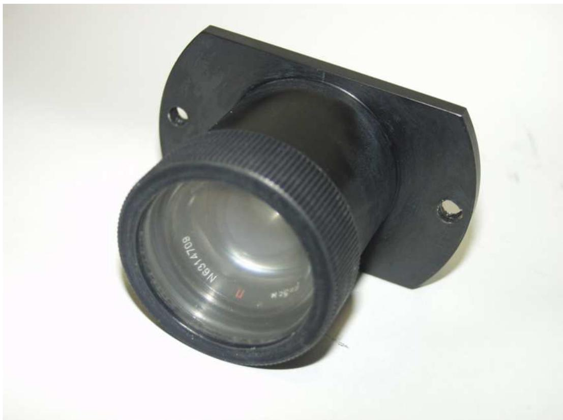
**Рис.14.6** Корпус объектива яркости восходящего излучения
