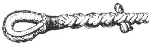
Рис. 6.78 Заделка конца синтетического троса с коушем
