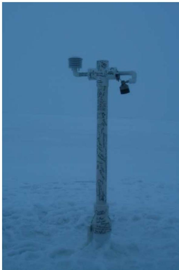
**Рис.17.21** Схематическое изображение измерительного комплекса SIMB и его внешний вид по завершению монтажа
