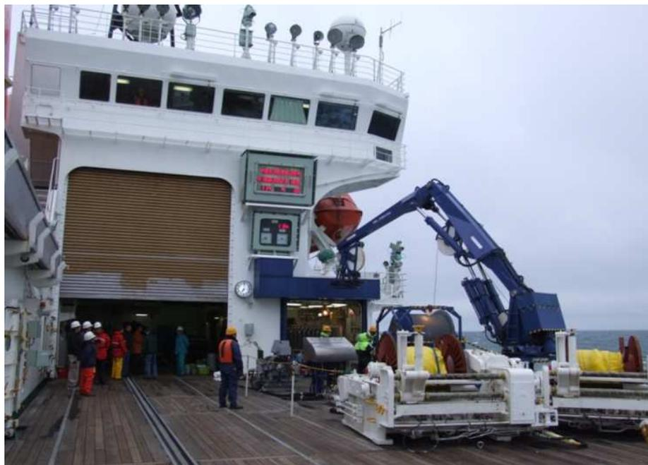
**Рис.6.1** Вид от кормы на выходы на рабочую палубу японского НИС Mirai. Слева большие сдвижные вверх ворота большой мокрой лаборатории-ангара. Справа – выход из той части мокрой лаборатории, где располагается наиболее часто выводимый в экспедициях на палубу инструмент – пробоотборник воды с присоединенным СТД зондом. При всех выходах из мокрой лаборатории на рабочую палубу отсутствуют какие-либо барьеры. Сверху (над палубой) центральный пост управления лебедками.
