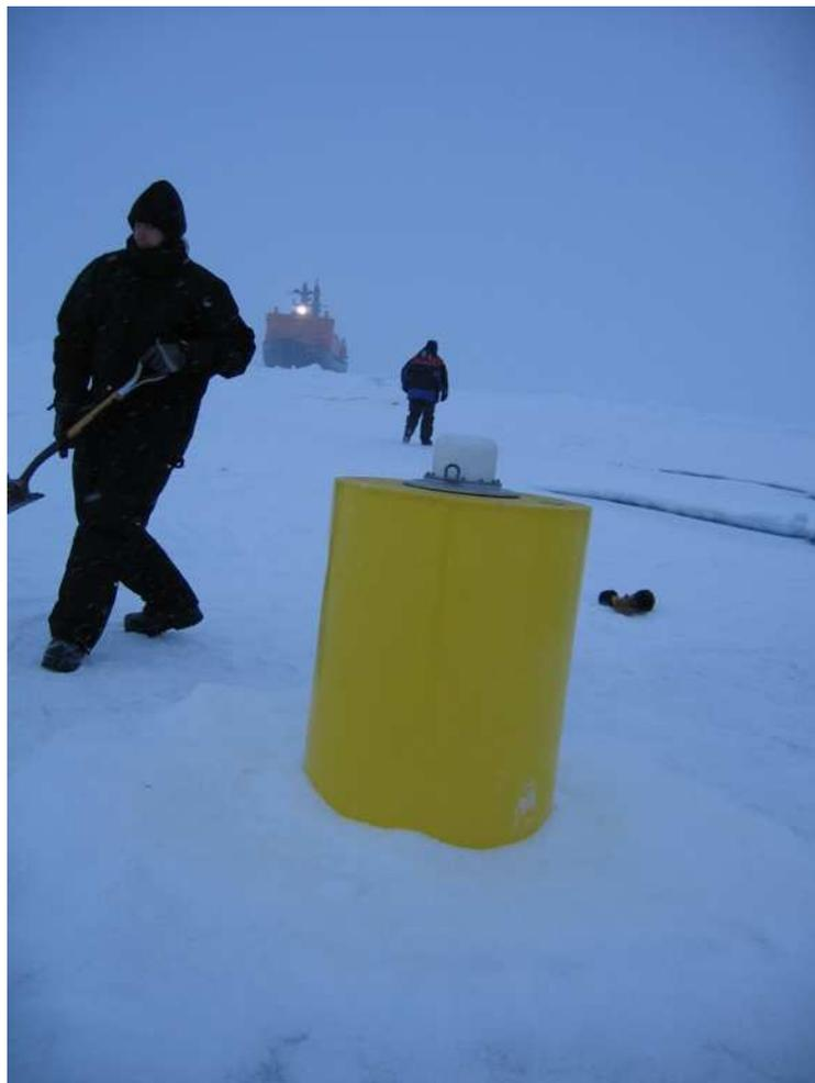
**Рис. 17.33** Буй профилографа на льду после окончания установки
