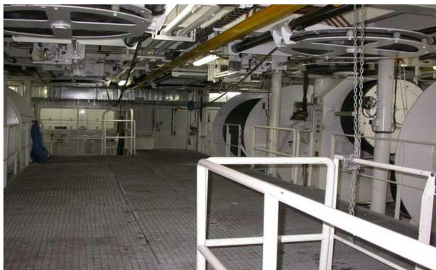
**Рис. 6.15** Расположение лебедок под рабочей палубой в кормовой части судна RV Pourquoiras
