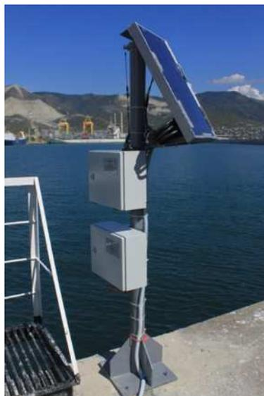
Комплексы гидрологические ГМУ-4 предназначены для измерений гидростатического давления с целью определения уровня воды, а также температуры воды в прибрежной зоне морей, водоемов, резервуаров.
