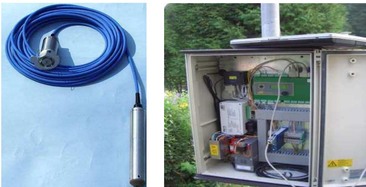
Рис.3.1. Гидростатический датчик (слева) и контроллер с оборудованием связи (справа) фирмы SEBA DST-22.
