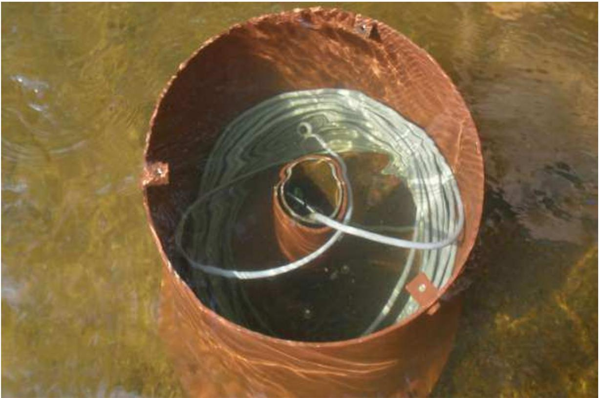
Рис.3.8. Вид на конструкцию установки гидростатического датчика.
