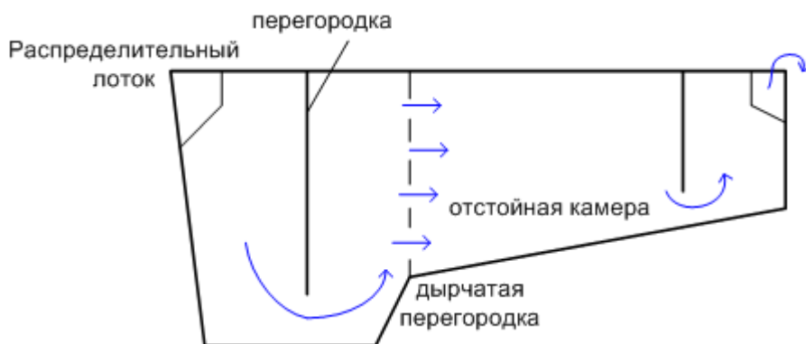
Рис. 6.1. Схема отстойника (механическая очистка сточных вод)
