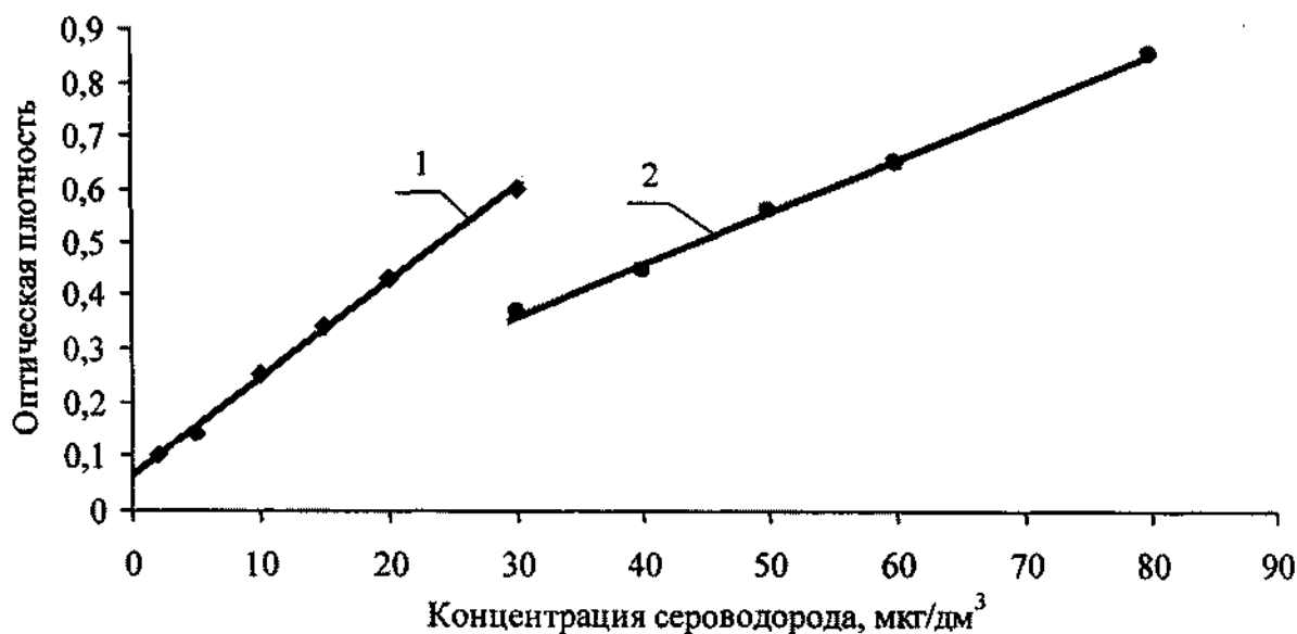
Рис. G.2. Градуировочные зависимости для экстракционно-фотометрических измерений на фотометрах, снабженных светофильтрами; светофильтр 670 нм
