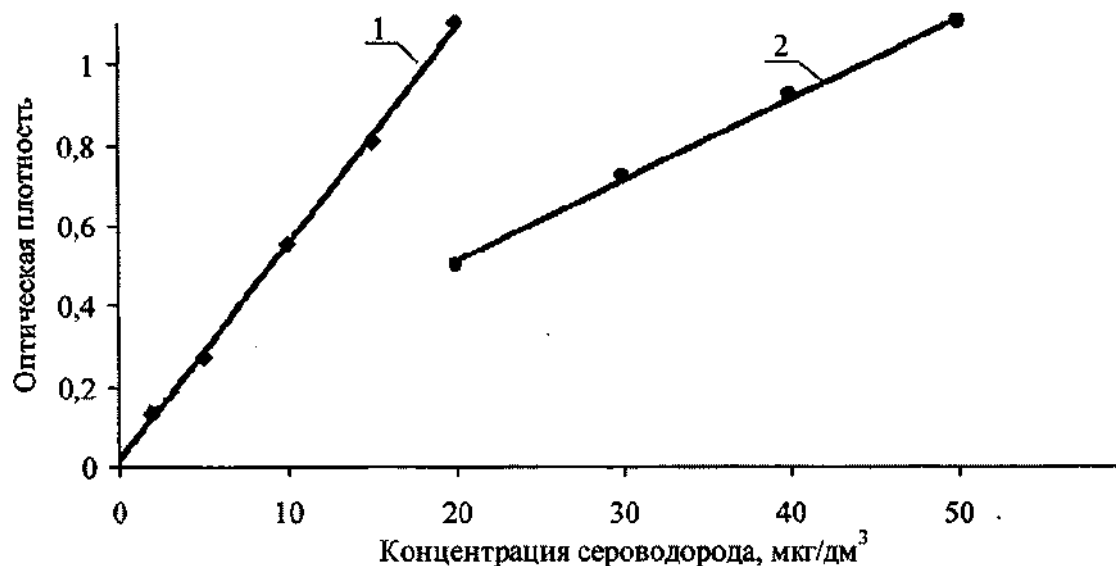
Рис. G.1. Градуировочные зависимости для экстракционно-фотометрических измерений на спектрофотометрах или фотометрах с непрерывной разверткой спектра при длине волны 656 нм
