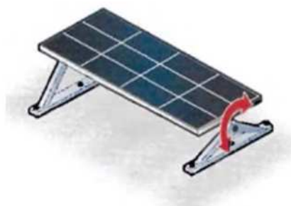
Рисунок 3 — Пример наклонной одноосной системы слежения за Солнцем
