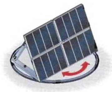
Рисунок 2 — Пример одноосной системы слежения за Солнцем с вертикальной осью вращения
