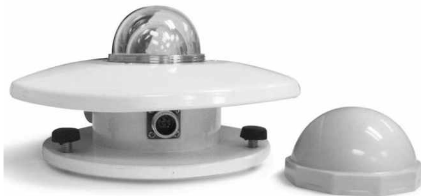
Рис.8.3. Радиационный пиранометр TBQ
