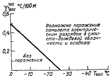
Рис. 8.1. График для прогноза зон возможного поражения самолетов электрическими разрядами в слоисто-дождевых облаках и осадках при устойчивой стратификации атмосферы.
