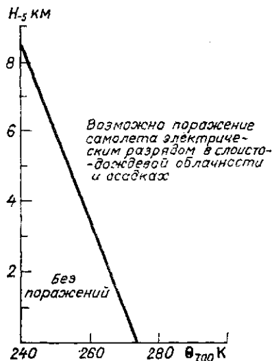
Рис. 8.3. График для прогноза опасных электрических зон в слоисто-дождевых облаках и осадках при нейтральной стратификации атмосферы.
