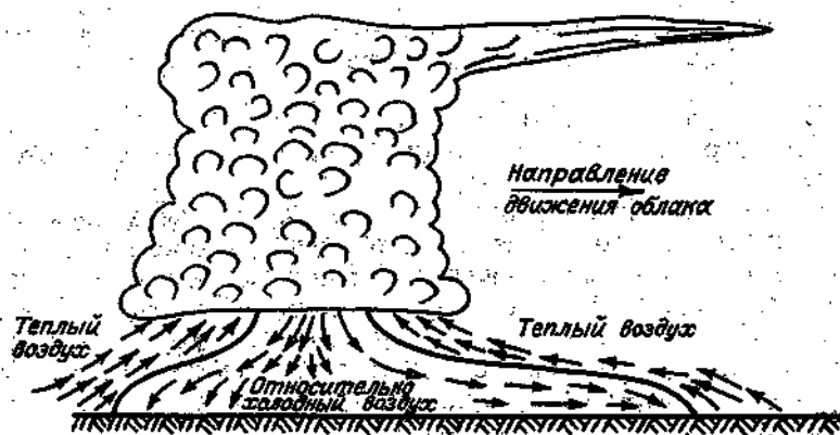
Рис. 1.12. Схема воздушных потоков в зоне фронта порывистости.
