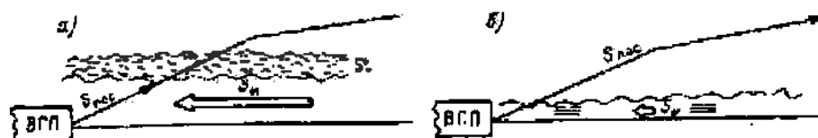
Рис. 9.3. Метеорологические ситуации, приводящие к различию между посадочной и метеорологической видимостью: а – S_{\text{пос}} < S_m ; б – S_{\text{пос}} > S_m .
