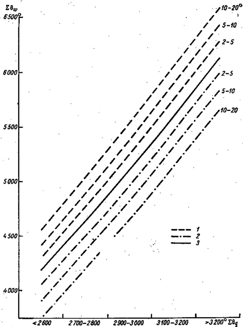
Рис. 42. Номограмма для расчета возможных сумм температур деятельной поверхности ( $\Sigma\theta_w$ ) за день на северных и южных склонах различной крутизны в разных районах Оренбургской области по дневным суммам температур воздуха выше  $10^\circ$  ( $\Sigma\theta_g$ ).
