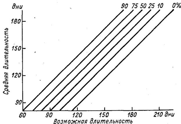
Рис. 57. Номограмма для расчета возможной длительности безморозного периода по различным средним ( $\sigma=16$ ).
