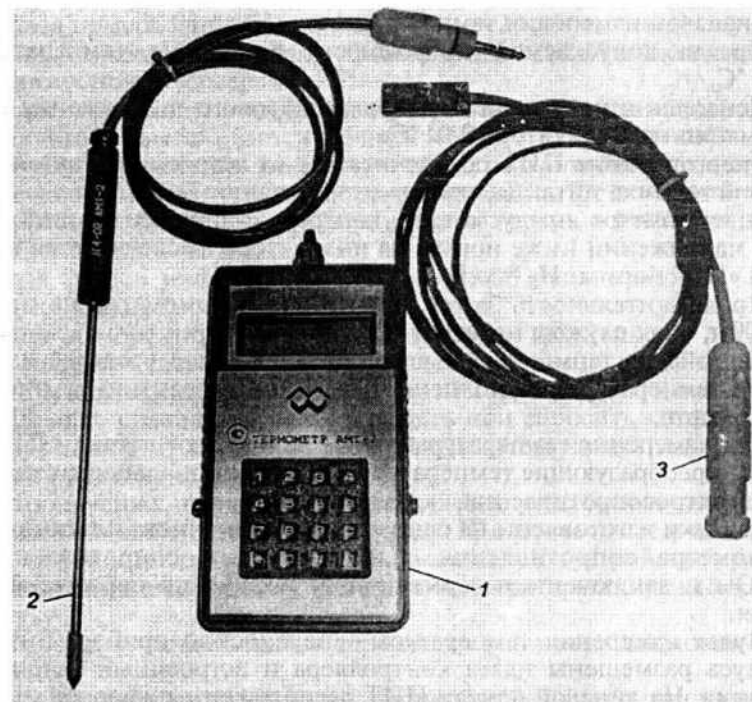
Рис. 2.10. Термометр электронно-цифровой АМТ-2:
