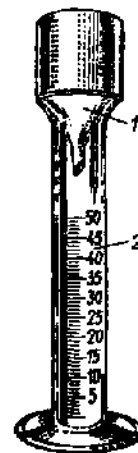
Рис. 5.2. Дождемер полевой М-99:
