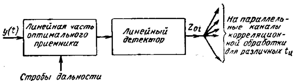
Рис. 5.45. Схема оптимальной обработки радиоимпульсов некогерентной пачки
