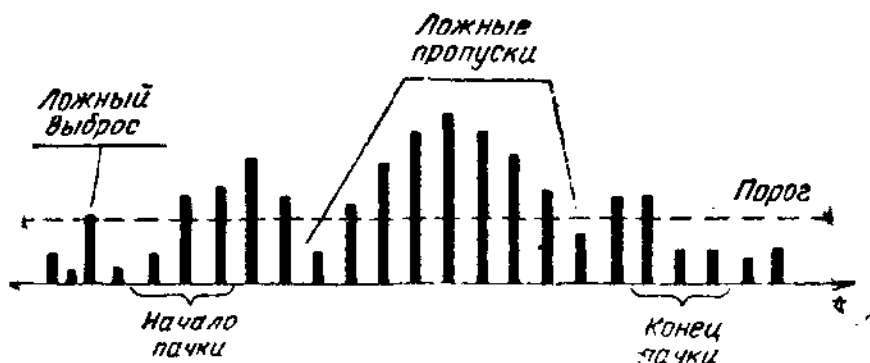
Рис. 5.51. Пояснение метода определения начала и конца пачки импульсов по логике «2 из 3»
