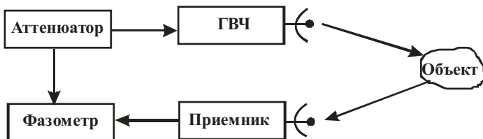
Рис. 12. Функциональная схема РЛС непрерывного излучения для определения дальности фазовым методом
