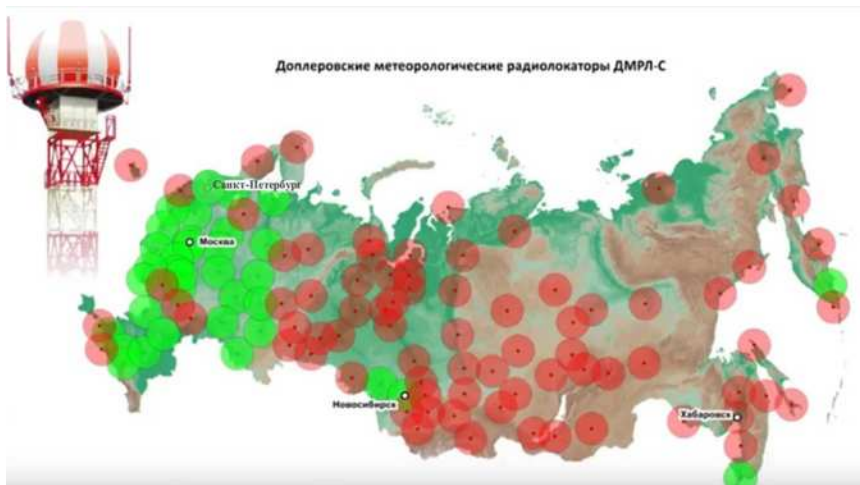
Рисунок 2. Схема расположения ДМРЛ-С на территории РФ (зеленые круги – введенные в эксплуатацию, красные круги неустановленные или нефункционирующие позиции по состоянию на 1 квартал 2018 г.)
