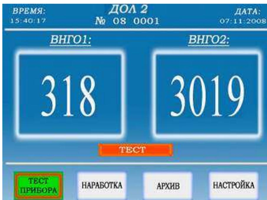
Рисунок А.13 – Индикация, аналогичная отображаемой на дисплее БУ в режиме “ТЕСТ”.
