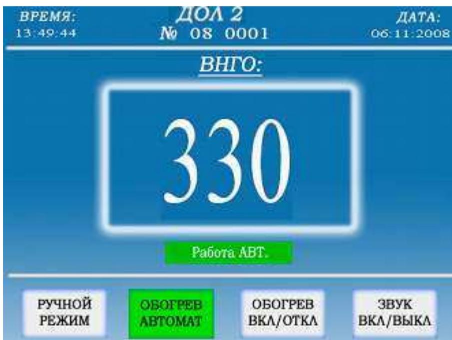
Рисунок А.8 – Работа БУ в автоматическом режиме
