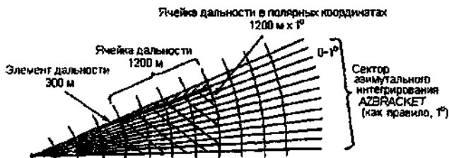
Рис. 6.1.1. Ячейка дальности и азимутальный сектор [9].
