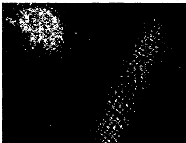
Рис. 1. Изображение наклонной полосы волнистых облаков на экране ИКО МРЛ-1, \varphi=2,5^\circ , M=100 км, метка дальности 10 км.
