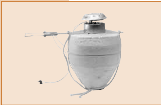
Радиозонд МРЗ-3А. Изготавливается с 80-х годов XX века.
