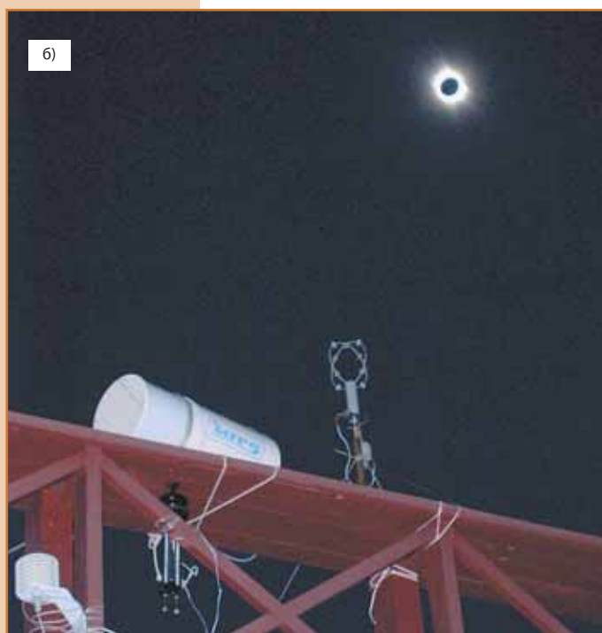
МТП-5 во время солнечного затмения (а - на высокогорной станции Шатжатмас в Приэльбрусье на высоте 2100 м, б- микроволновый профилемер во время полного солнечного затмения 29 марта 2006 года).
