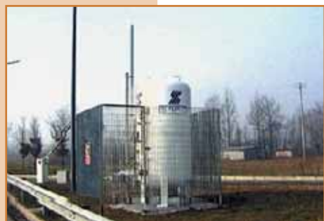
Наземные генераторы мелкодисперсных частиц льда – стационарный и передвижной.
