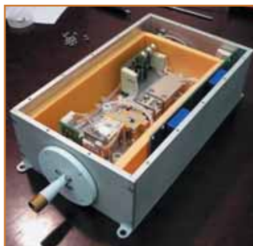
СВЧ радиометры диапазона 60 ГГц (слева - прямого усиления, справа - супергетеродинный)
