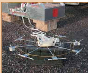
Аппаратура для тестирования датчиков радиозондов на земле (снимок слева) и в полёте (снимок справа).
