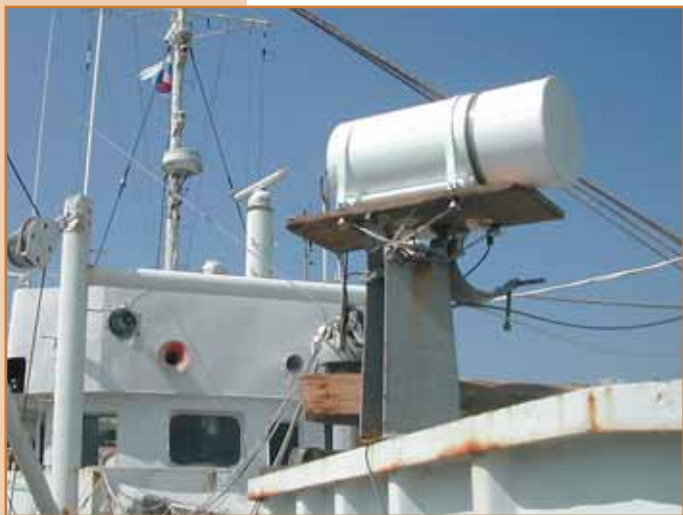
МТП-5 на исследовательском катере. (Голубая бухта, г. Геленджик Краснодарского края, 2006 г., совместная экспедиция ИФА РАН и ЦАО).
