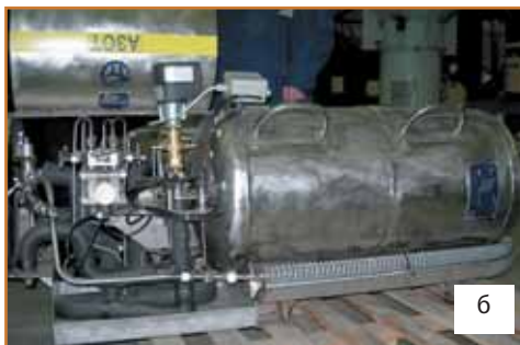
Самолётный генератор мелкодисперсных частиц льда - ГМЧЛ-А, (а- ГМЧЛ-первого поколения, б- второго).
