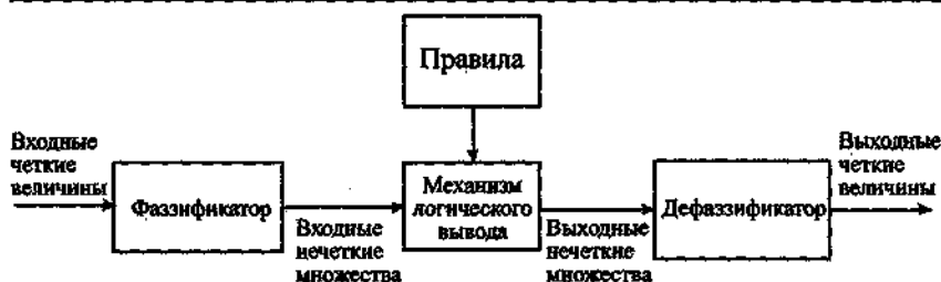
Рис. 3.16. Общая схема системы нечеткой логики [15].
