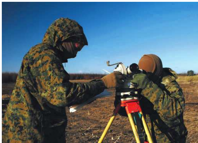
Рис. 1. Определение угловых координат шар-пилота с помощью аэрологического теодолита в полевых условиях
