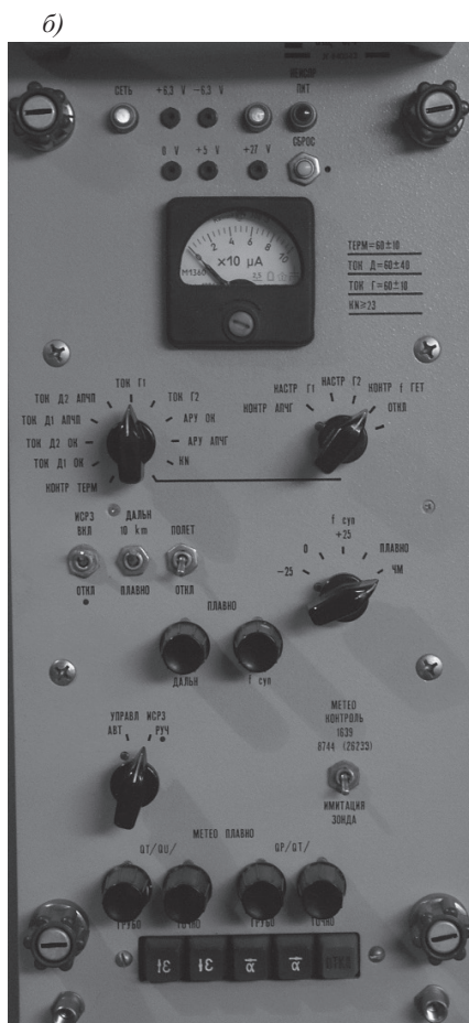
Рис. 7.6. Внешний вид блоков РПМК-1: а) Блок БЦ5.2; б) Блок БЦ6.4
