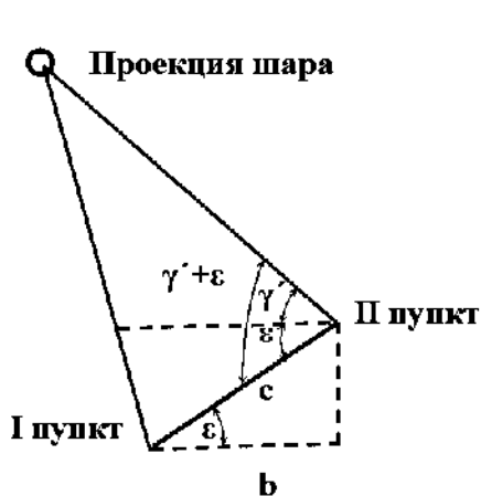
Рис. 5.17. Значение угла (\gamma' \pm \varepsilon) при втором положении пунктов. Случай 3. Горизонтальные углы \alpha < 90^\circ или \alpha > 270^\circ и \beta < 90^\circ или \beta > 270^\circ |\gamma' - \varepsilon|
