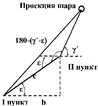
Рис. 5.16. Значение угла (\gamma' \pm \varepsilon) при втором положении пунктов. Случай 2. Горизонтальные углы 90^\circ < \alpha < 270^\circ и 90^\circ < \beta < 270^\circ |\gamma' + \varepsilon|
