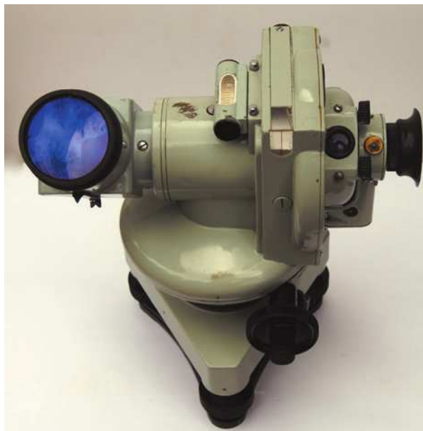
Рис. 2.1 (Начало). Внешний вид и детали аэрологического теодолита
