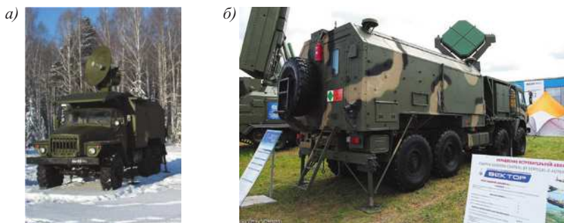
Рис. 7.1. Передвижная радиолокационная станция температурно-ветрового зондирования: а) РПМК-1; б) модернизированная РПМК
