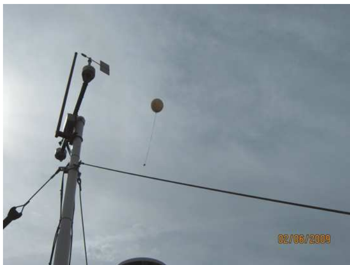
Рис. Пб.2. Последний запуск радиозонда с крыши 1-го корпуса РГГМУ, 02.06.2009
