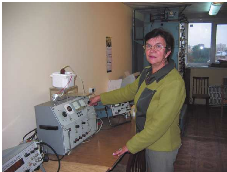
Рис. 6.9. Проверка электронного блока радиозонда на КИПАС
