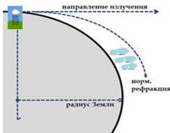
Рисунок 10.3 – Подъем радиолокационного луча над поверхностью Земли
