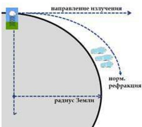
Рисунок 6.5 Подъем радиолокационного луча над поверхностью Земли.
