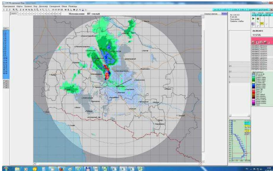
Рисунок 6.13 Карта ОЯ ДМРЛ-С «Мин.Воды» за 20.09.14 г., 17:57 ВСВ. Узкий сектор в направлении ССЗ экранирован мощной конвективной облачностью Сб со шквалами, грозами, ливнями, расположенной вблизи ДМРЛ, оказался «пустым», без явлений.
