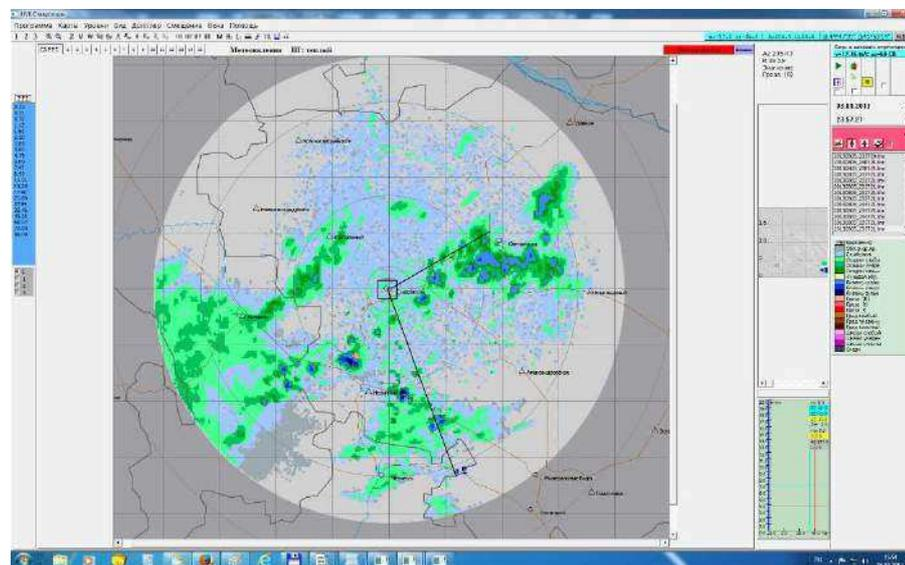
Рисунок 6.16 Карта метеоявлений в режиме Inv, с удаленными сигналами «повторного эха».
