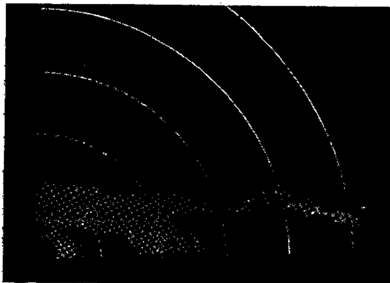
Рис. 4.31. Вертикальный разрез высоко-слоистых и слоисто-дождевых облаков с полосой выпадающих осадков на ИДВ. Масштабные метки через 4 км.
