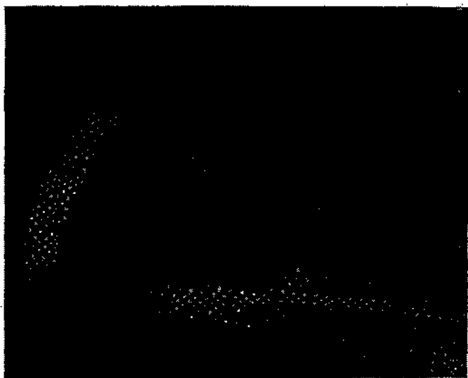
Рис. 4.19. Радиоэхо слоя таяния (яркая полоса) на ИДВ.
