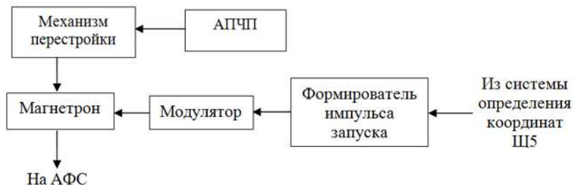
Рис. 6. Структурная схема передающей системы
