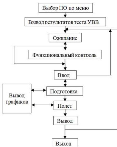
Рис. 16. Возможные переходы между различными режимами ПО.
