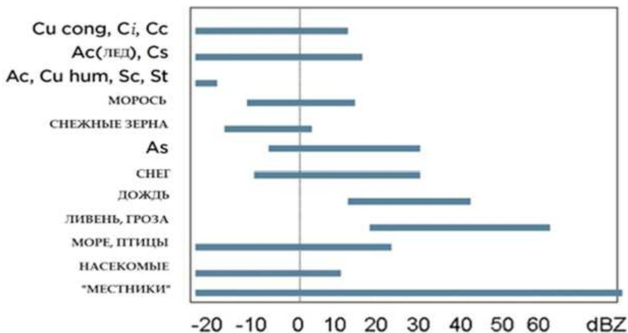
Рис. 11. Значения радиолокационной отражаемости для различных источников радиоэха
