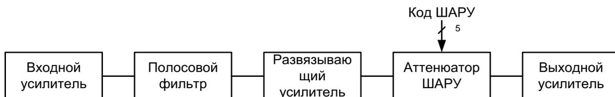
Рисунок 11 – Функциональная схема ячейки Д2УР082
