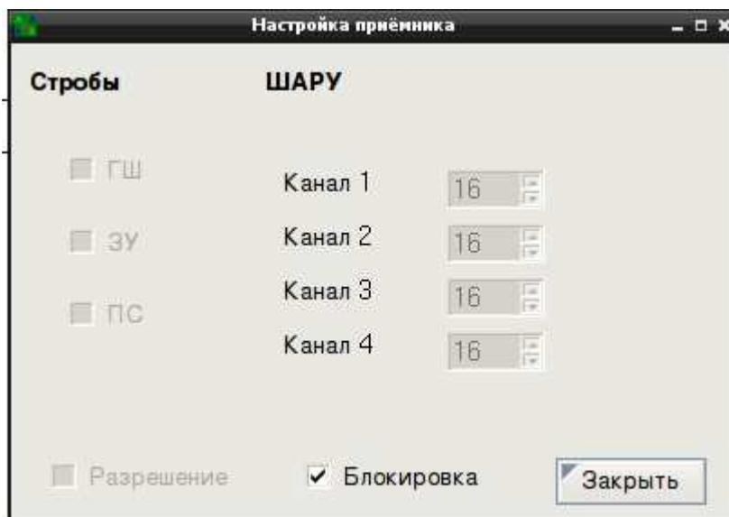
Окно «Настройка приемника» предназначено для разрешения ручного изменения коэффициентов ШАРУ, включения/отключения ГШ, ЗУ, ПС путем выбора «Блокировка/Разрешение».
