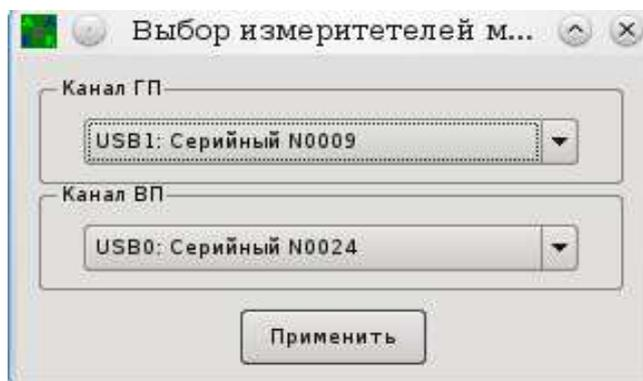
Для корректного измерения импульсной мощности при замене USB-измерителей необходимо ввести в данном окне номера измерителей мощности на разных поляризациях и нажать кнопку «Применить».
