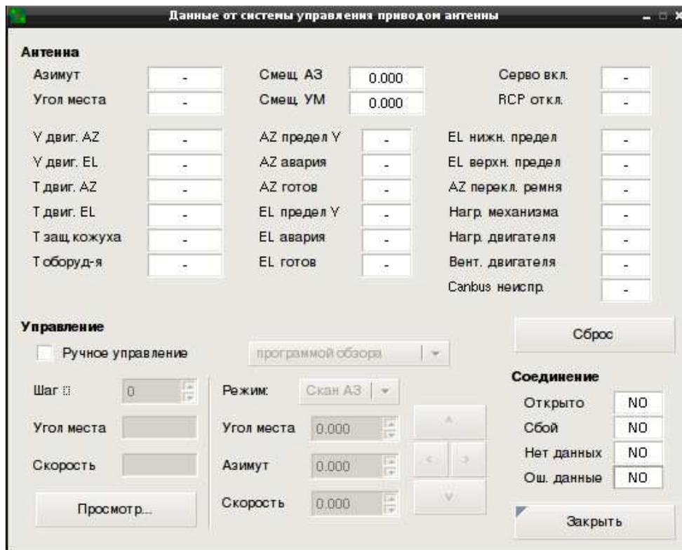
В данном окне отображаются данные идущие от блока управления антенной (RVP900) на систему контроля и управления:
