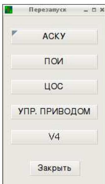
Диалоговое окно «Удаленный перезапуск» позволяет перезапустить ЦУВК («АСКУ»), программу первичной обработки информации («ПОИ»), модуль цифровой обработки сигналом («ЦОС»), компьютер управления приводом антенны («Упр. Приводом»), а также модуль синхронизации («V4»).
