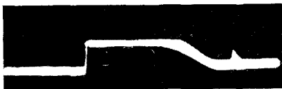
Рис 10.3 Изображение на экране индикатора импульса «звона»
