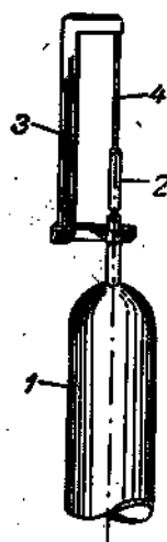
Рис. 179. Схематический чертеж самолетного измерителя водности в облаках при отрицательных температурах.
