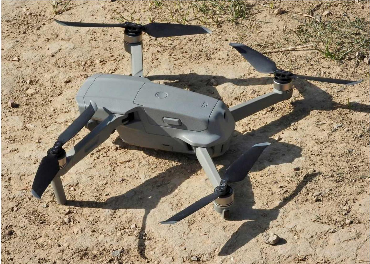
Вес – 0,43 кг, время полёта – 21 мин, дальность передачи сигнала – 4 км, высота полёта над точкой запуска – 500 м, фото-видеокамера: видео в формате 4K / 60fps и фотографии с разрешением 48 Мп.
