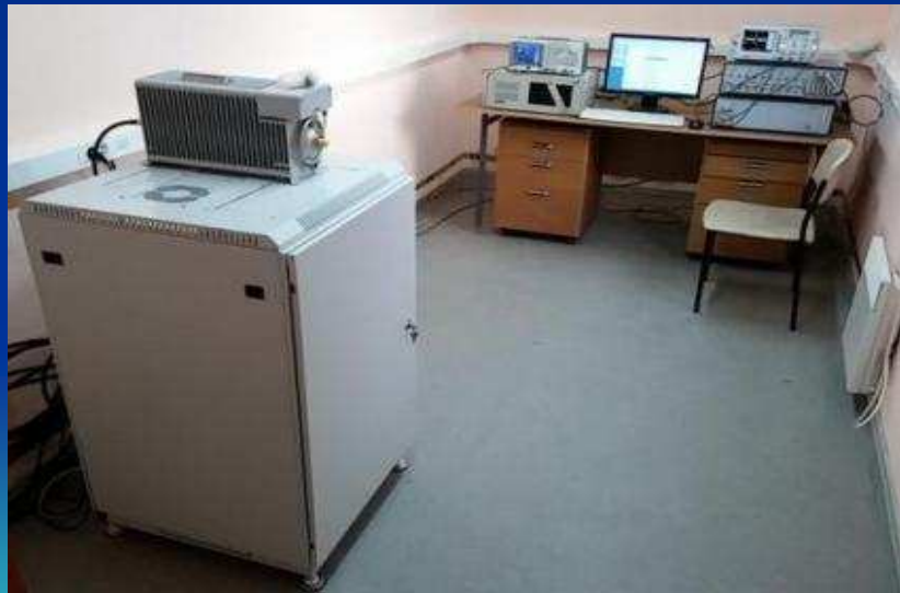
Приемопередающая и управляющая аппаратура метеорной РЛС внутри аппаратного бокса
