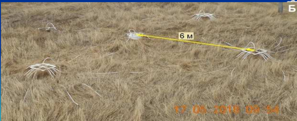
А – типовая геометрия инфразвуковой группы (п. Начики, Камчатка).
