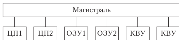
Рис. 3.2. Магистральная архитектура ЭВМ
