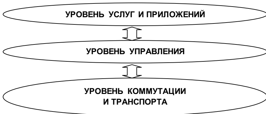
Рисунок 1.3. Уровневая архитектура сети следующего поколения
