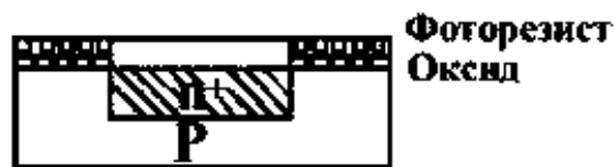
Рис. 4.3. Удаление засвеченного фоторезиста и находящегося под ним оксидного слоя.
