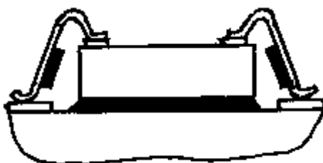
Рис.5.2. Ленточный монтаж кристалла на коммутационную плату
