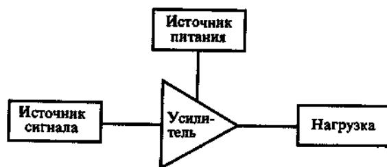
Рис. 18.1 Обобщенная схема включения усилителя
