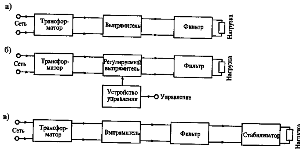
Рис. 29.6. Структурные схемы ИВЭП с трансформаторным входом: с нерегулируемым выпрямителем (а), с регулируемым выпрямителем (б) и со стабилизатором (в)
