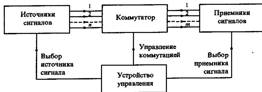
Рис. 11.1 Структурная схема коммутации источников и приемников сигналов
