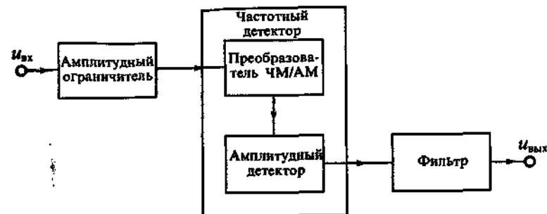
Рис. 25.7. Структурная схема частотного демодулятора
