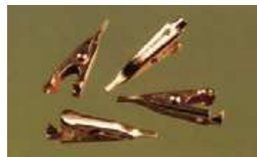
Рис. 3.22. Эти маленькие зажимы отводят тепло, защищая компоненты во время их припайвания
