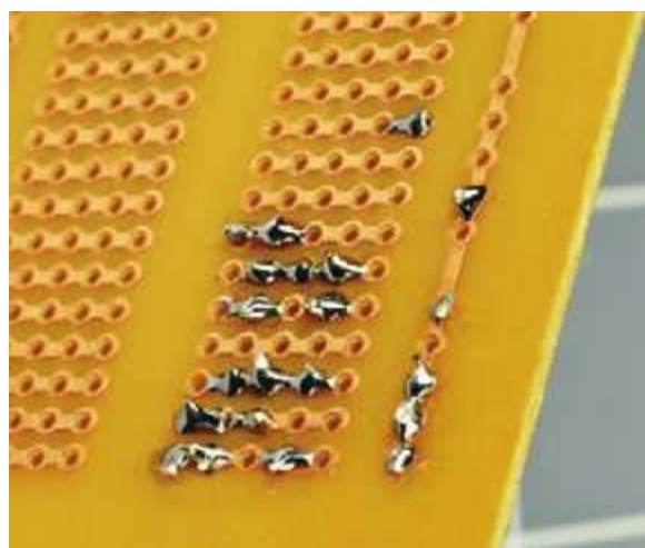
Рис. 3.79. После припаивания излишки выводов и проводов откусывают, а качество выполненных соединений проверяют с помощью увеличительного стекла. Затем могут быть вставлены следующие два или три компонента и процесс повторяется
