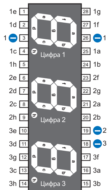
Рис. 4.32. Этот семисегментный индикатор BC56–11EWA компании Kingbright содержит три индикатора в одном корпусе и может управляться тремя последовательно соединенными десятичными счетчиками 4026. Номера выводов показаны на ИС. Сегменты от «а» до «g» индикатора цифры 1 идентичны выводам, обозначенным от «1а» до «1g». Сегменты от «а» до «g» индикатора цифры 2 соответствуют обозначениям от «2а» до «2g». Сегменты от «а» до «g» индикатора цифры 3 соответствуют обозначениям от «3а» до «3g»
