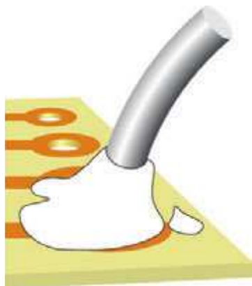
Рис. 3.80. Если вы использовали слишком много припоя, то это может создать некачественный вид и нежелательные соединения с другими проводниками
