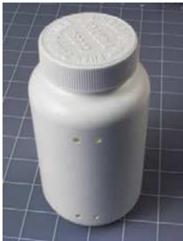
Рис. 5.60. Большая пустая бутылка из-под витаминов диаметром 3" (76,2 мм) представляет собой идеальный каркас для катушки детекторного приемника. Просверленные отверстия будут удерживать провод, намотанный на бутылке
