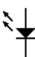
Рис. 2.43. Иногда светодиоды изображают с кружком вокруг символа диода; иногда нет. В этой книге я везде добавляю кружок. Стрелки означают излучение света
