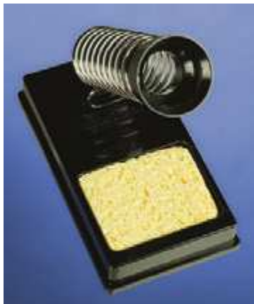
Рис. 3.13. Безопасная и простая подставка для паяльника
