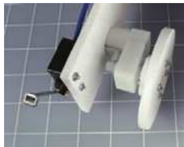
Рис. 5.96. Крепление одного микропереключателя на левом переднем углу тележки
