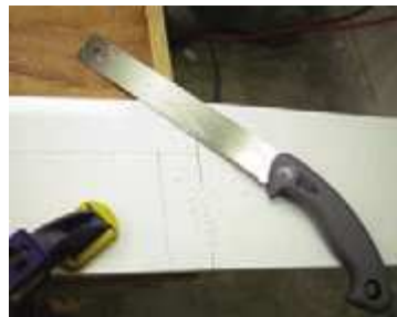
Рис. 5.79. Это так называемая японская ножовка, которая в основном пилит, когда вы тянете на себя, а не толкаете от себя. После некоторой практики вы сможете использовать ее для выполнения очень аккуратных разрезов. Поскольку АБС-пластик достаточно мягкий материал, затраты при его распиливании очень невелики
