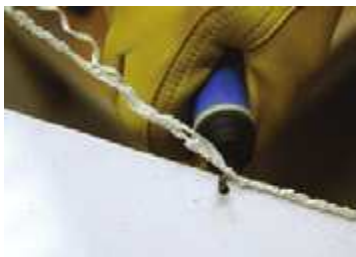
Рис. 5.81. Инструмент для удаления заусениц будет очищать и закруглять отрезанный край куска пластика всего лишь за несколько быстрых проходов
