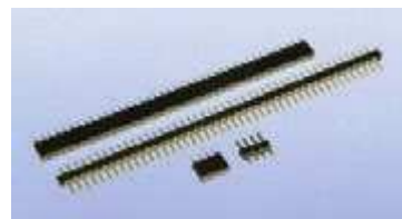
Рис. 3.29. Монтажная многоконтактная колодка с гнездами (вверху) и штырьками (в середине) дает возможность выполнять очень компактные соединения. Их можно распилить или разрезать, разделив на маленькие секции (внизу). Расстояние между контактами 0,1" (2,54 мм)
