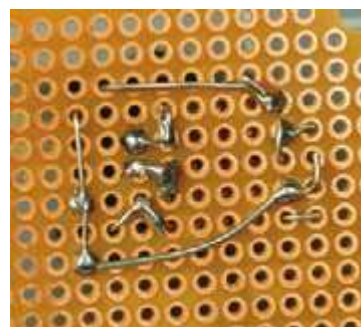
Рис. 3.62. Собранный проект на плате — вид с обратной стороны. Медные контактные кружки вокруг каждого отверстия платы не являются обязательными для данного проекта. На некоторые из них попадает какое-то количество припоя, но это не имеет значения, поскольку при этом не создаются неумышленные короткие замыкания
