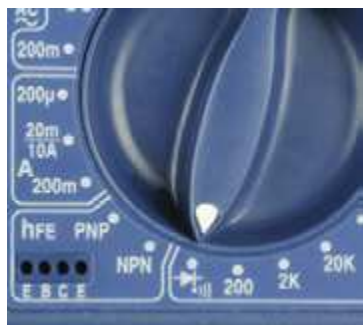
Рис. 2.29. Чтобы прозвонить цепь, нужно в вашем мультиметре повернуть переключатель режимов в положение, обозначенное символом, показанным на рисунке. Функцией прозвона следует пользоваться только тогда, когда на компоненты или в цепи, которые вы проверяете, напряжение не подано
