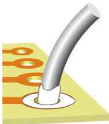
Рис. 3.81. Слишком мало припоя (или недостаточный прогрев) может привести к покрытию вывода компонента припоем без соединения его с покрытой припоем медной площадкой на перфорированной плате. Даже зазор толщиной с человеческий волос достаточен для отсутствия электрического контакта
