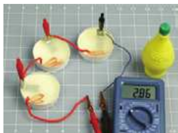
Рис. 1.62. Лимонный сок из бутылок будет «работать» так же хорошо, как и свежавыжатый. Я отрезал нижние части трех бумажных стаканчиков, вставил в них оцинкованные кронштейны и использовал куски толстого медного многожильного провода для изготовления положительных электродов
