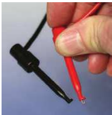
Рис. 3.6. Эти клипсы (мини-захваты) измерительных проводов мультиметра значительно упрощают процесс измерения. Нажатие пружинистой кнопки клипсы будет приводить к выдвиганию небольшого медного контактирующего крючка. После подключения им к оголенному выводу или проводу надо отпустить кнопку. После этого руки освобождаются для выполнения других задач. Для меня это какая-то загадка, почему мультиметры изначально не поставляются с измерительными проводами с этими клипсами в качестве стандартного оборудования
