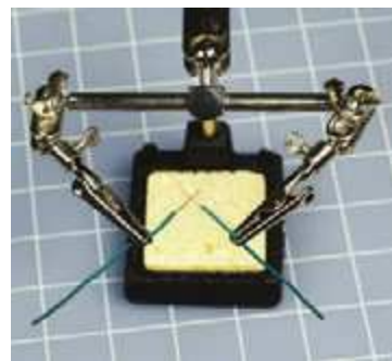
Рис. 3.31. На рисунке показан держатель типа «третья рука», когда в нем зафиксированы два провода с касающимися друг друга оголенными проводами. Увеличительное стекло должно быть убрано в сторону в течение всего процесса выполнения пайки
