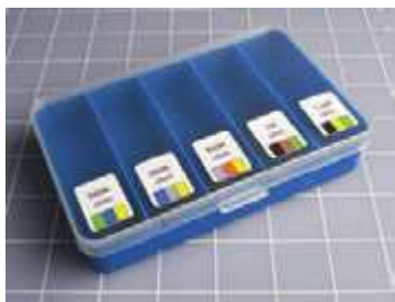
Рис. 5.6. Чтобы сразу видеть, что резисторы находятся в соответствующем отсеке, нужно на каждой наклейке напечатать цветовую кодовую маркировку резистора
