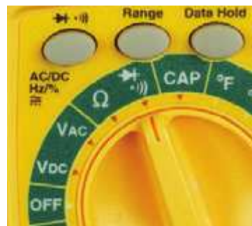
Рис. 2.29. Чтобы прозвонить цепь, нужно в вашем мультиметре повернуть переключатель режимов в положение, обозначенное символом, показанным на рисунке. Функцией прозвона следует пользоваться только тогда, когда на компоненты или в цепи, которые вы проверяете, напряжение не подано
