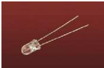
Рис. 1.14. Типичный светодиод диаметром 5 мм
