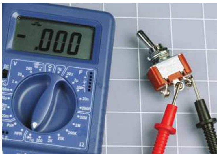
Рис. 2.30. Когда переключатель замкнет контакты, то между соответствующими его выводами, к которым подсоединены измерительные щупы мультиметра, установленного в режим прозвона, прибор будет показывать нулевое сопротивление, и при этом еще будет раздаваться звуковой сигнал
