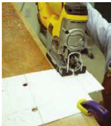
Рис. 5.80. Этот лобзик DeWalt может двигаться с очень медленной скоростью, что дает возможность выполнить необходимую работу с пластиком точно и аккуратно
