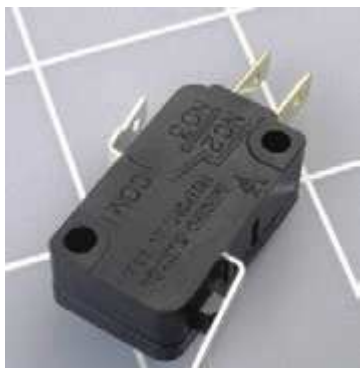
Рис. 5.74. Микропереключатель имеет маленькую кнопку (показана на переднем плане, справа), которая очень часто приводится в действие закрепленным металлическим рычажком. Микропереключатель может срабатывать под воздействием очень небольшого усилия, но в состоянии переключать относительно большой ток
