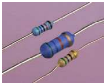
Рис. 1.38. Пример трех резисторов с цветовой маркировкой. Номиналы приведенных резисторов (сверху вниз) следующие: 56 000, 5600 и 560 Ом. Размер резистора указывает на мощность, которую он может выдержать; эта мощность никак не влияет на его сопротивление. Два крайних резистора меньшего размера имеют мощность 0,25 Вт, а резистор большего размера рассчитан на 1 Вт
