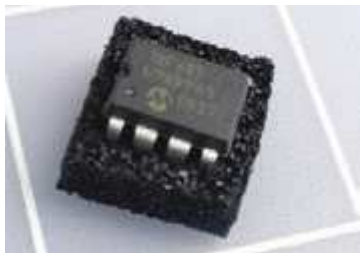
Рис. 5.122. При приобретении микроконтроллер PICAXE 08M обычно установлен на проводящую губку. Микроконтроллер имеет те же размеры, что и 555 таймер 555, но обладает вычислительной мощностью небольшого компьютера
