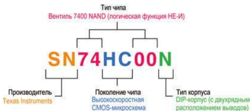
Рис. 4.4. Посмотрите на микросхему семейства (74xx, в данном случае) нужного поколения (в данном случае HC — высокоскоростной КМОП-(CMOS-)микросхемы) в маркировке. Убедитесь, что вы приобретаете микросхему именно в DIP-корпусе, а не в корпусе для поверхностного монтажа. Производитель не имеет значения
