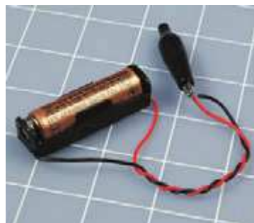
Рис. 1.28. Замыкание щелочной батарейки может быть безопасным, если вы будете точно следовать приведенным далее указаниям. Даже в этом случае батарейка может стать слишком горячей, что касание к ней может вызвать неприятные ощущения. Обращаю ваше внимание на то, что в эксперименте не следует использовать аккумуляторы любого типа!
