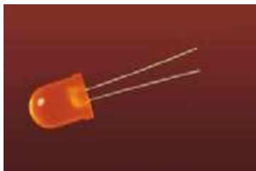
Рис. 1.15. Светодиод большого размера (диаметром 10 мм) обладает большой яркостью свечения, которая в данном случае не нужна, и к тому же такой светодиод стоит дороже. В принципе для большинства экспериментов, приведенных в этой книге, можно купить любые светодиоды, которые вам больше понравятся
