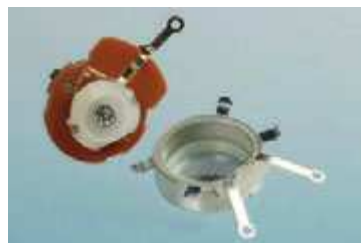
Рис. 1.43. Чтобы открыть потенциометр, сначала надо отогнуть четыре небольшие металлические лапки, расположенные по краю металлического корпуса (на нижнем рисунке видно две лапки, отогнутые наружу — одна влево и одна вправо). Внутри находится однослойная спираль из проволоки, намотанной вокруг плоской пластмассовой полоски, и пара подпружиненных контактов, которые проводят ток к нужной точке или отводят от другой нужной точки катушки при вращении оси потенциометра (показаны на верхнем рисунке). В зависимости от того, какого типа потенциометр у вас есть, относительно недорогой или более дорогой, внутри их вы можете обнаружить дорожку проводящей графитовой пленки или проволочную спираль. В любом случае используемый принцип действия будет один и тот же
