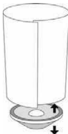
Рис. 2.101. Динамик излучает звук от своей нижней поверхности точно так же, как и от верхней. Чтобы увеличить полезную составляющую аудиосигнала, можно использовать картонную трубку для разделения источников звука или установить динамик в небольшой корпус
