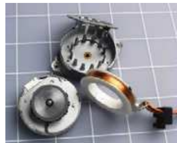
Рис. 5.113. Если разобрать шаговый двигатель, то это будет что-то похожее на это, что вы обнаружите внутри. Слева показан ротор двигателя, который имеет магнитный пояс по окружности, он прочно прикреплен к нижней половине корпуса. Справа верхняя половина корпуса в открытом состоянии и со снятыми катушками (фактически, как вы можете видеть, обмотка состоит из двух катушек, намотанных в противоположном направлении). Выступы это магнитные сердечники, которые приводят в движение ротор
