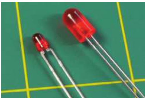
Рис. 4.6. Логическая микросхема поколения HC спроектирована так, что каждый ее вывод может выдать всего лишь 4 мА. Этого недостаточно для того, чтобы загорелся стандартный светодиод диаметром 5 мм (справа), который потребляет ток 20 мА. Миниатюрные светодиоды с низким потреблением тока (слева) требуют всего лишь 1 мА с последовательно подключенным резистором, что является идеальным для схем, в которых вы хотите иметь выход с минимальным количеством проблем
