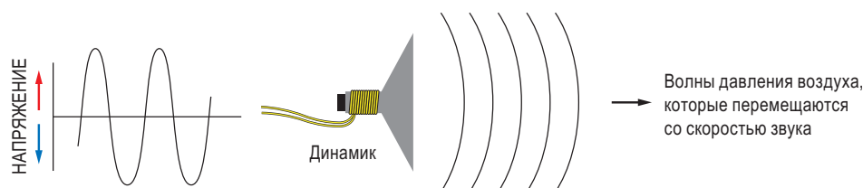
Рис. 5.32. Четвертый шаг процесса: усиленный электрический сигнал проходит через катушку динамика. Магнитное поле, созданное током, заставляет вибрировать диффузор динамика, который таким образом будет воспроизводить исходный звук
