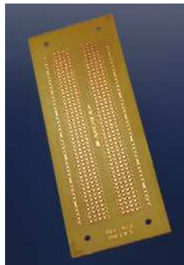
Рис. 3.53. Перфорированная плата с протравленными медными дорожками, расположенными таким же образом, как и на макетной плате. Это пример платы, которая может быть использована при выполнении эксперимента 15
