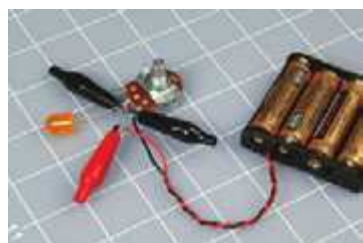
Рис. 1.46. Светодиод, приведенный на этой фотографии, вдруг сгорел, поскольку я излишне уменьшил сопротивление потенциометра
