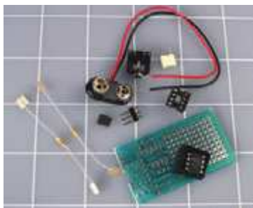
Рис. 5.123. Типичный набор элементов с микроконтроллером PICAXE включает в себя печатную плату, которая вам, может быть, и не понадобится, и некоторые другие не слишком существенные компоненты. Но гнездо 3,5-мм для стереосигнала (показанное сверху, в центре) абсолютно необходимо
