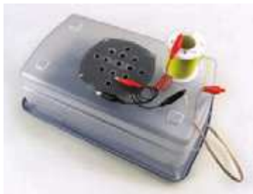
Рис. 5.43. Красный и черный «крокодилы», которые лежат на верхней части обувной коробки, должны быть подключены к выходу вашего усилителя. Провод с красным зажимом пропускает сигнал через катушку монтажного провода, когда сигнал проступает на динамик. Обратите внимание на изменения в звуке, когда вы будете подключать катушку
