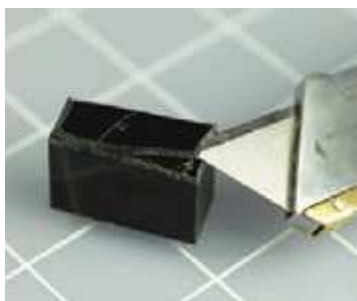
Рис. 2.50. Вставьте лезвие ножа в узкий просвет и, пользуясь ножом, как рычагом, отделите верхнюю часть корпуса, затем повторите эту процедуру для боковых сторон
