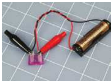
Рис. 1.31. Когда вы присоедините оба провода к предохранителю, то маленький проволочный его элемент в форме буквы «S» будет почти мгновенно расплавлен
