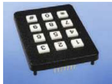
Рис. 4.10. При покупке цифровой клавиатуры нужно выбирать клавиатуру с 12 кнопками с компоновкой «кнопочного телефона», которая должна иметь по меньшей мере 13 контактов. Контакты здесь можно заметить на переднем крае печатной платы клавиатуры
