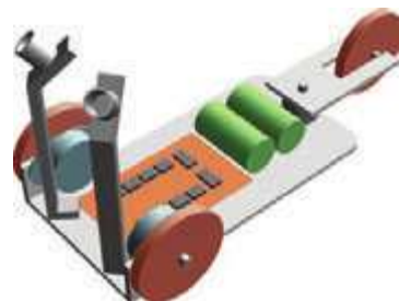
Рис. 5.120. Данное изображение в 3D-формате показывает возможный вариант конструкции роботизированной тележки,двигающейся по лучу, с двумя фоторезисторами, прикрытыми небольшими трубками для ограничения их угла зрения
