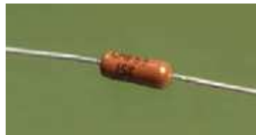
Рис. 1.37. Некоторые современные резисторы имеют нанесенные на их цифровые значения сопротивления, хотя вам для их чтения может потребоваться лупа. Этот резистор номиналом 15K (15 кОм) имеет длину менее половины дюйма (около 12 мм)
