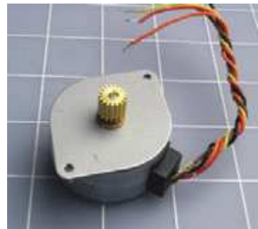
Рис. 5.104. Типичный шаговый двигатель. Ось двигателя вращается шагами, когда отрицательные импульсы последовательно подаются на четыре провода, а пятый провод является общим и подключается к положительному выводу источника питания
