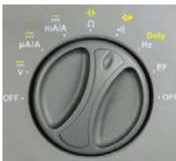
Рис. 2.29. Чтобы прозвонить цепь, нужно в вашем мультиметре повернуть переключатель режимов в положение, обозначенное символом, показанным на рисунке. Функцией прозвона следует пользоваться только тогда, когда на компоненты или в цепи, которые вы проверяете, напряжение не подано
