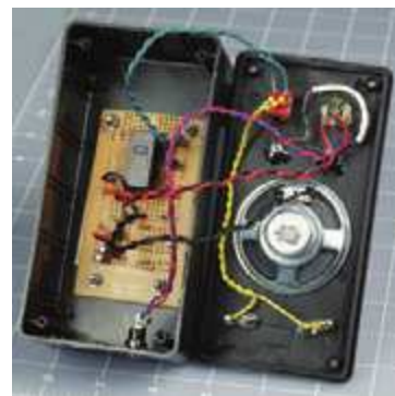
Рис. 3.90. Плата была установлена на дно корпуса, а гнездо для подачи напряжения питания было ввинчено в нижнюю стенку корпуса. Скрученные пары проводов были подсоединены по принципу прямого соединения, без всяких попыток сделать расположение проводов более компактным, поскольку данный проект относительно небольшой. В верхнем правом углу на передней панели показана белая термоусадочная трубка, которая защищает оголенные выводы резистора с сопротивлением 680 Ом и его соединение с проводами. Припаивание проводов к кнопке требует большой осторожности и точности, поскольку ее выводы расположены очень близко друг от друга
