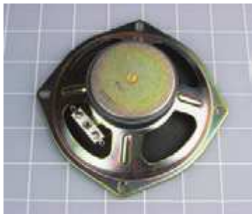
Рис. 5.35. Чтобы услышать результат работы звуковых фильтров, выполненных с использованием катушек и конденсаторов, вам потребуется динамик, который в состоянии воспроизводить низкие частоты. Этот динамик диаметром 5" (127 мм) имеет минимально необходимый размер
