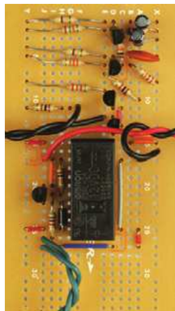
Рис. 3.83. Монтажная схема системы охранной сигнализации с добавленной схемой управления реле, выполненной на биполярном транзисторе. С концов проводов внешних устройств была снята изоляция, провода вставлены в перфорированную плату и затем припаяны к ней. Два зеленых скрученных между собой провода (показаны внизу слева) соединяют схему с датчиками, два черных скрученных провода (находятся в центре платы) подключены к динамике, а красный (припаян слева) и черный (припаян справа от реле) подключены к источнику питания
