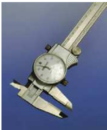
Рис. 3.19. Штангенциркули могут быть цифровыми, которые автоматически преобразовывают миллиметры в доли дюймов от 1/64 до 1/1000, или аналоговыми как тот, который приведен на фотографии. В этом случае вам, разумеется, не придется беспокоиться о замене батареек
