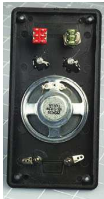
Рис. 3.88. Компоненты были установлены на передней панели корпуса (вид с обратной стороны). Динамик был приклеен к данному месту. Оставшийся клей был нанесен на светодиоды, но только на их корпуса. Однополюсный двухпозиционный переключатель типа «Вкл./Выкл.» находится справа сверху, двухполюсная двухпозиционная кнопка без фиксации — сверху слева и контактные клеммы, к которым будут подключены провода герконовых переключателей датчиков, установлены внизу
