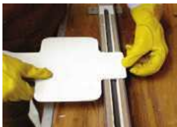
Рис. 5.85. Выполнение чистых точных изгибов АБС-пластика это просто не-большое по времени пребывание пластика на гибочном устройстве, которое состоит практически из одного электрического нагревательного элемента
