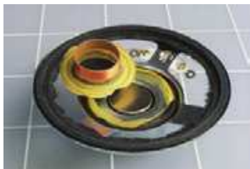
Рис. 5.27. Горловина диффузора должна быть извлечена. Обратите внимание на катушку из медной проволоки, которая входит в углубление между двумя магнитами в основании динамика
