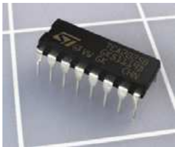
Рис. 5.36. Эта микросхема содержит в себе стереоусилитель, который в состоянии выдавать на динамик сопротивлением 8 Ом сигнал мощностью 5 Вт, в том случае когда используются сразу два канала
