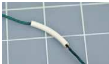
Рис. 3.42. Наденьте трубку на ваше соединение проводов
