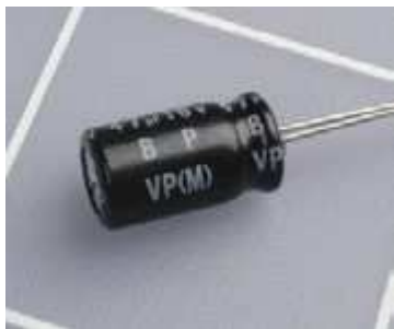
Рис. 5.37. Неполлярный электролитический конденсатор, который иногда называют биполярным конденсатором, выглядит точно так же, как и обычный полярный электролитический конденсатор, за исключением того, что на корпусе он имеет обозначение «NP» или «BP»
