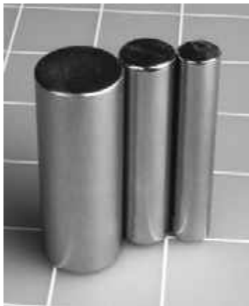
Рис. 5.20. Три неодимовых магнита диаметром 1/4" (6 мм), 1/2" (13 мм) и 3/4" (19 мм). Я хотел сфотографировать их на расстоянии около 15 мм друг от друга, но они этого не позволили
