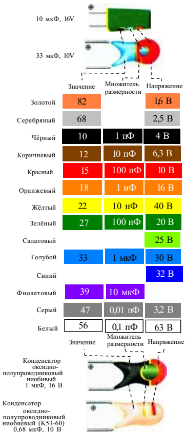
Рис. 2.10. Цветовая маркировка электролитических конденсаторов
