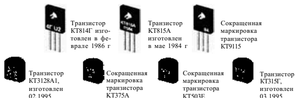
Рис. 6.7. Буквенно-цифровая полная и сокращённая маркировки отечественных транзисторов в корпусах КТ-26 (ТО-92) и КТ-27 (ТО-126)
