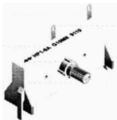
Рис. 1.19. Буквенно-цифровая маркировка наборов высокоомных резисторов
